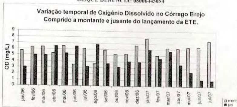
Figura 7: Variação temporal da concentração de Oxigênio Dissolvido no Córrego Brejo Comprido a montante e a jusante do lançamento da ETE.
