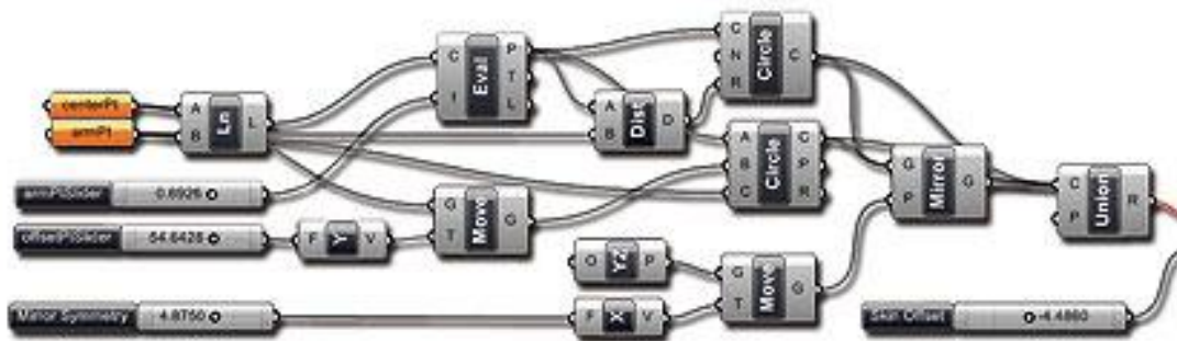
Figura 34: Componentes conectados através de seus inputs e outputs Fonte: http://aecmag.com/index.php?option=com_content&task=view&id=293&Itemid=32
