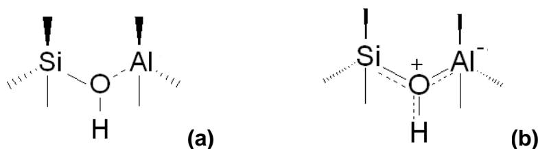
Figura 9: Primeiro modelo de estrutura química para os sítios hidroxilas nas zeólitas, que considera que o grupo Si-OH está apenas sendo influenciado pelo alumínio (a); e modelo aperfeiçoado que passa a considerar a existência de uma real ligação química entre oxigênio e alumínio (b). 12
