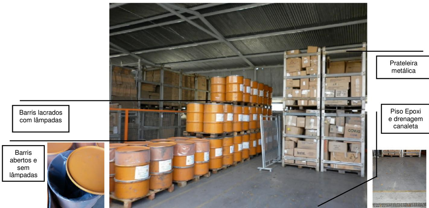
Figura 19 – Área de armazenagem das lâmpadas inservíveis da CEMIG
