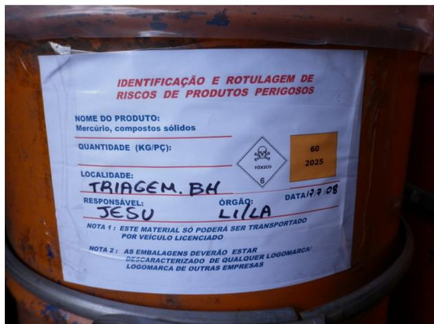
Figura 21 – Barril com identificação e rotulagem específica de riscos de produtos perigosos
