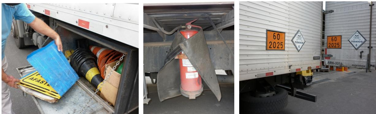
Figura 23 – Equipamentos de segurança e sinalização de veículos que transportam resíduos classe I (Coleta CEMIG)
