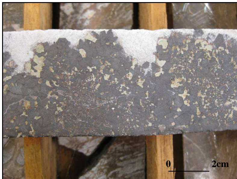
Figura 3.15 - Amostra de testemunho de sondagem CQ 89, amostra n° 228313, próximo a 93,75m de profundidade. Nelsonito P3, composto predominantemente por magnetita e pirocloro (cristais marrom claro) e tetra-ferriflogopita subordinada. Observe bolsão de carbonatito branco com grãos de tetra-ferriflogopita e magnetita subordinados.
