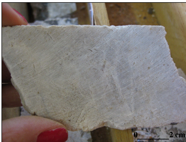
Figura 3.5 -Amostra de testemunho de sondagem, CQ 48, n° 215403, próximo a 111m de profundidade. Carbonatito branco, homogêneo e puro, representante do envelope externo ao depósito.
