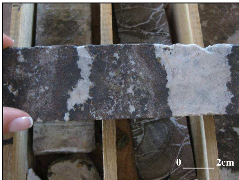
Figura 3.13 - Amostra de testemunho de sondagem CQ 45, n° da amostra: 187706, próximo a 133m de profundidade. Dique de nelsonito no meio de um carbonato com fragmentos de fenito. Presença de bolsões de carbonato com magnetita na borda.
