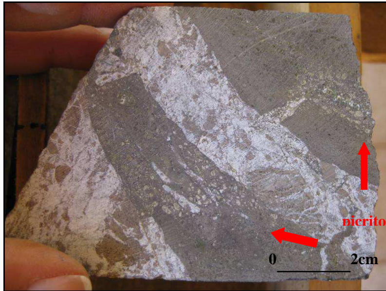
Figura 3.16 - Amostra de testemunho de sondagem CQ 93, amostra n° 228044, próximo a 93,3m de profundidade. Dique de flogopita picrito intrudindo carbonatito rico em flogopita brechóide.
