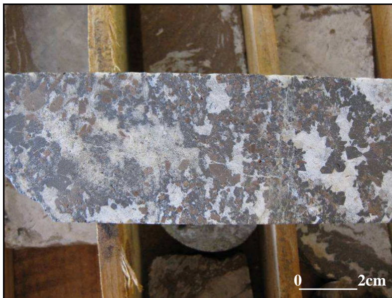
Figura 3.11 - Amostra de testemunho de sondagem CQ 134, amostra n° 253661, próximo a 113,62m de profundidade, mostrando o aspecto geral de nelsonito com quantidades subordinadas de pirocloro e tetra-ferriflogopita em comparação a Figura 3.10.
