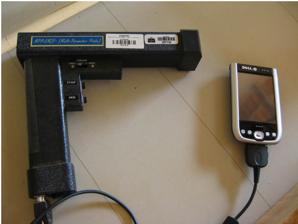
Figura 4.2 - Aparelho Hand- Held Conductivity & Magnetic Susceptibility Meter DDD MPP-EM2S + Multi Parameter Probe utilizado no levantamento de dados.
