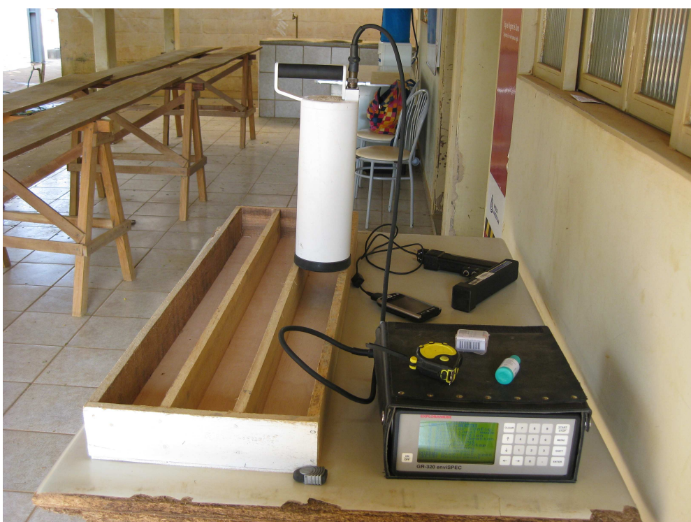
Figura 4.5 - Aparelho gamaespectrômetro portátil GR-320, fabricado pela Exploranium, utilizado no levantamento de dados.
