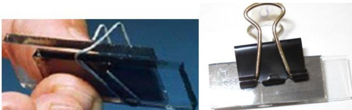
Figura 3. 5 – Amostras confeccionadas com duas lâminas de substrato de vidro recoberto com FTO, baseada no modelo de Grätzel.
