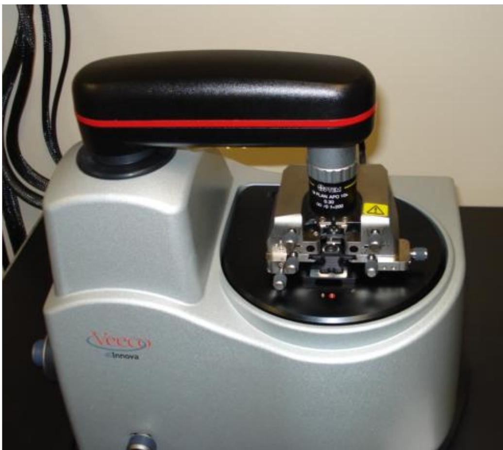
Figura 3. 4 – Vista frontal do AFM, marca VEECO Innova
