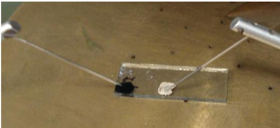
Figura 3. 12 – Ilustração da polarização direta para amostras com P3HT, e gota de PEDOT/PSS, para medidas das curvas (I–V).
