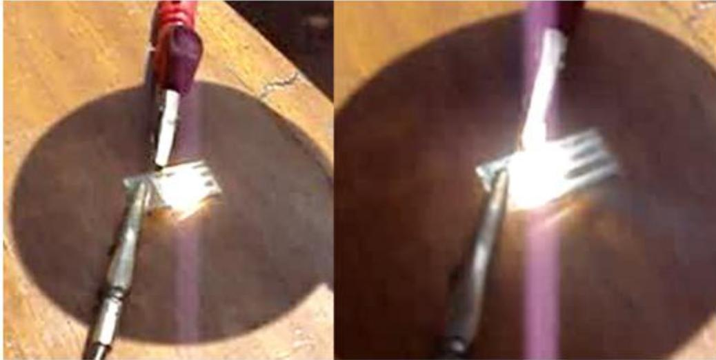
Figura 3. 11 – Ilustração do experimento realizado com uma amostra, tendo o contato desenhado com a geometria em forma de trilhas, camada ativa de PS: OB 47%.
