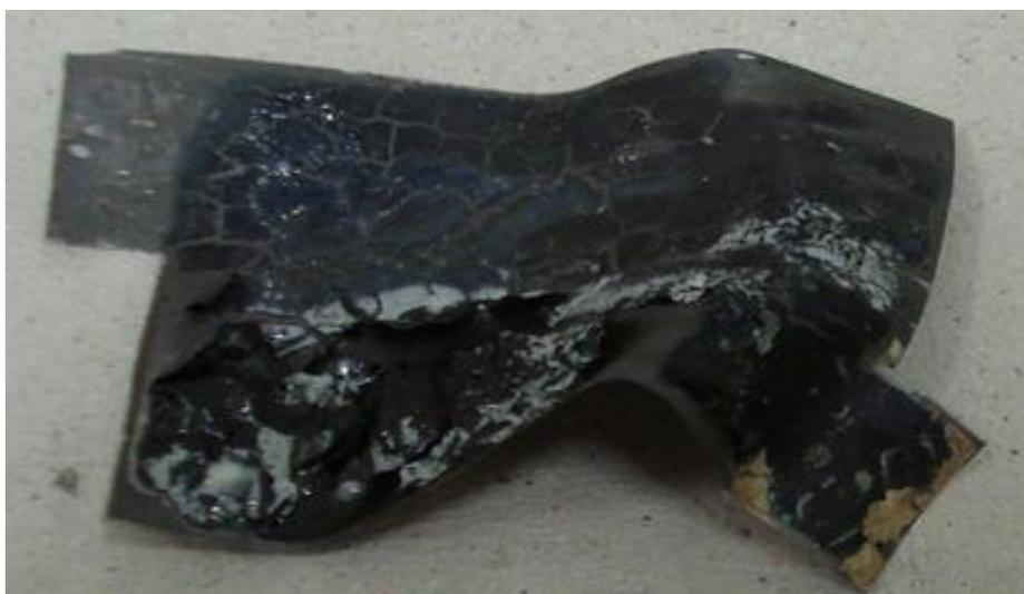
Figura 3. 7 – Amostra feita com substrato de PET após ser submetidos à fonte de lâmpada incandescente de 100 W por 20 minutos.
