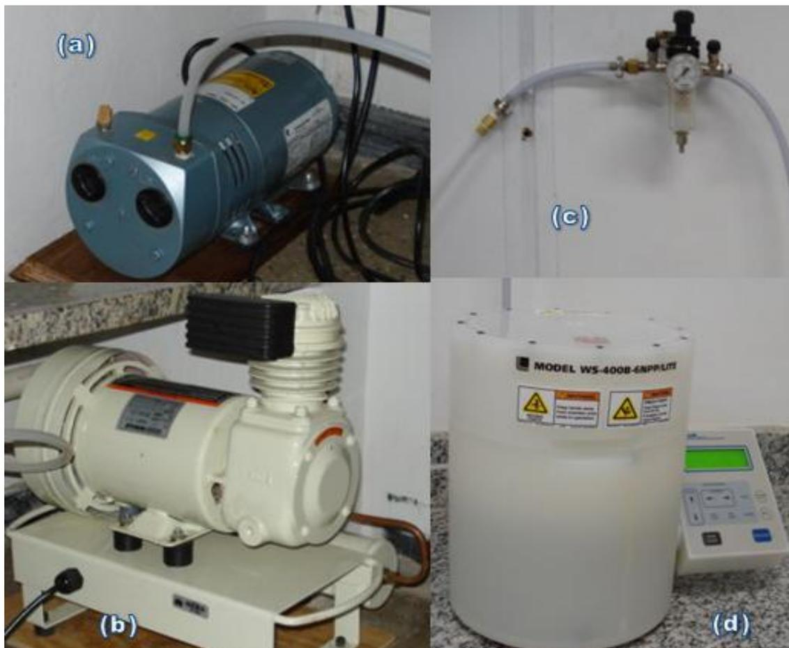
**Figura 3. 1** – (a)bomba de vácuo; (b) compressor de ar comprimido; (c) válvula de controle e (d) *spin coater*.
