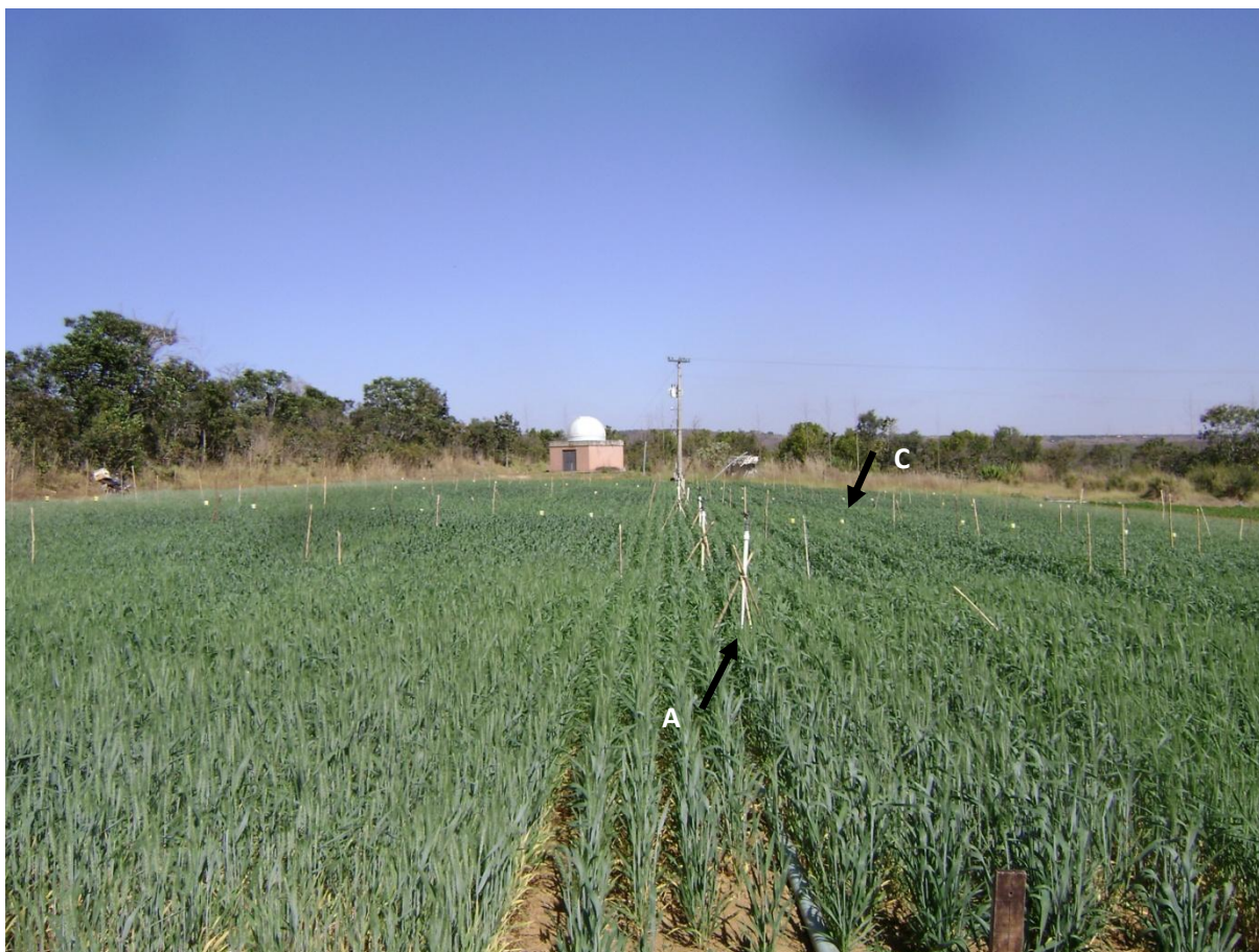
Figura 2. Sistema montado com linha central de aspersores (A) e três linhas perpendiculares de coletores (C) na Fazenda Água Limpa da Universidade de Brasília
