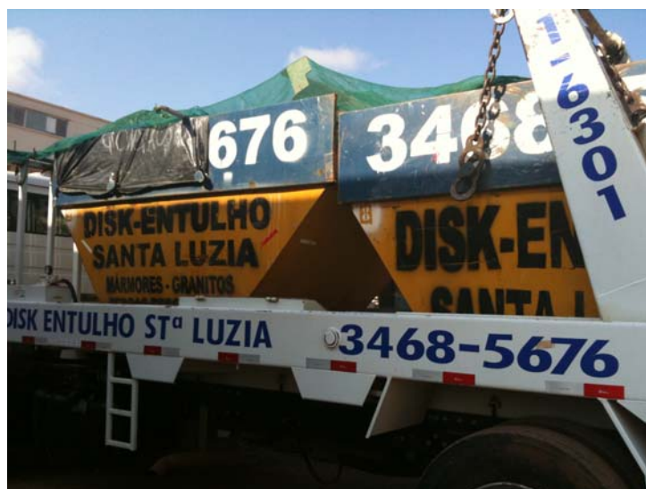
Foto 4: Caminhão poli-guindaste e caçambas.
