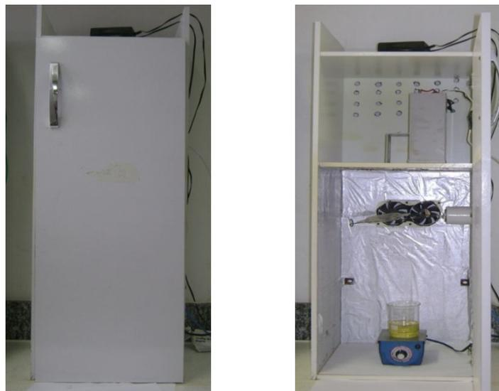
**Figura 18-** Foto-reator desenvolvido no laboratório.
