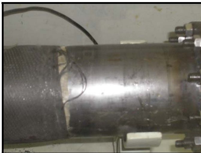
Figura 5.39: Início do estufamento da extremidade direita do tubo reparado.
