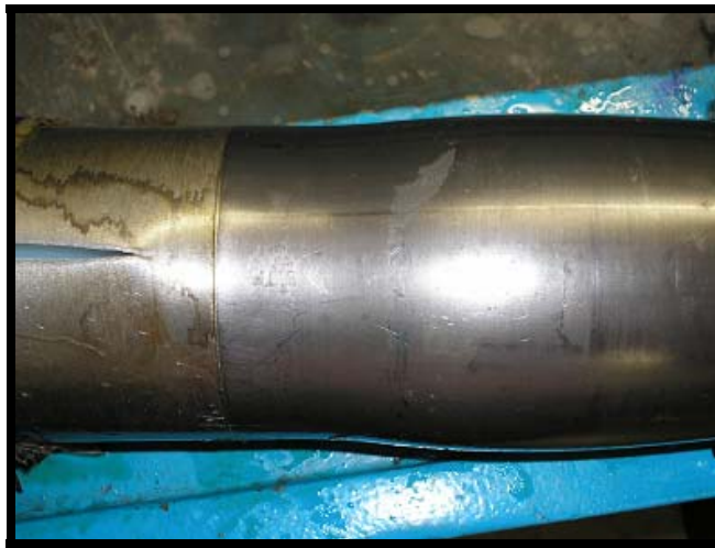
Figura 5.51: Ênfase para o estufamento do tubo na região próxima à tampa e para o estrangulamento exatamente na posição prevista pelo Compshell.
