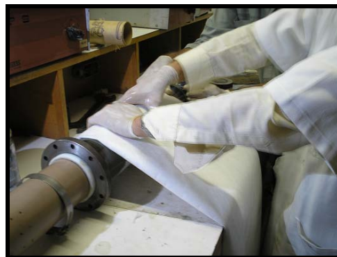
Figura 3.22: Colocação do filme absorvente ao redor do tubo.
