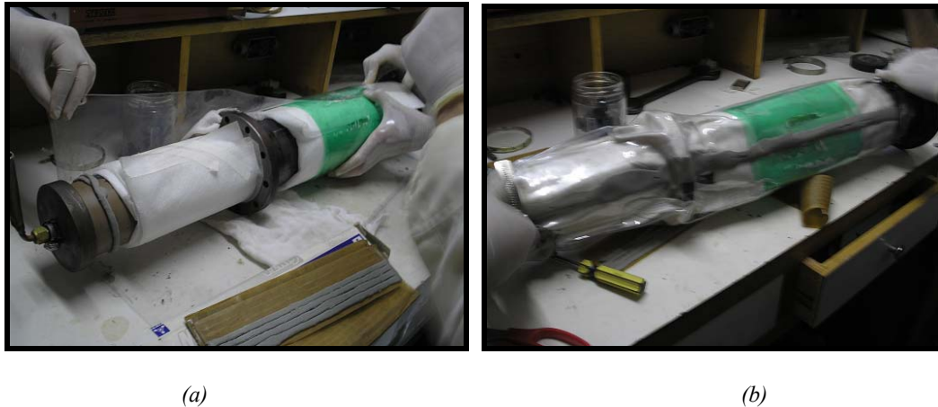
Figura 3.26: (a) Colocação da bolsa de vácuo ao redor do tubo; (b) Vedação da bolsa de vácuo.
