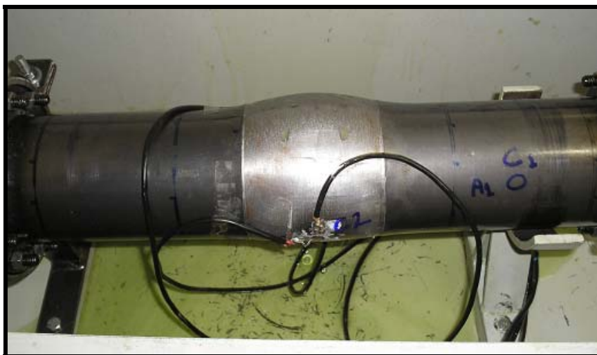
Figura 5.21: Estufamento máximo na região central no momento da ruptura do tubo.
