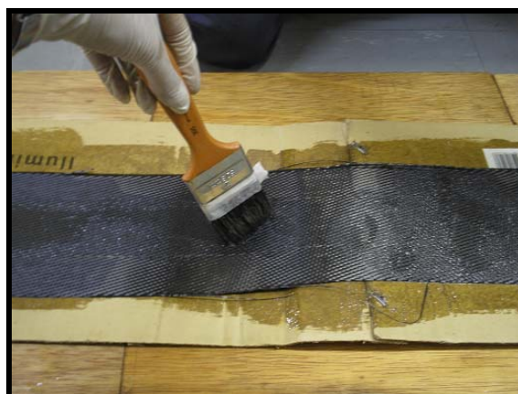
Figura 3.19: Impregnação de matriz na primeira camada do laminado.
