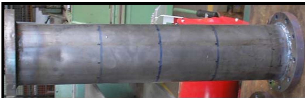
Figura 3.7: Tubo íntegro com as marcações necessárias para sua identificação geométrica.
