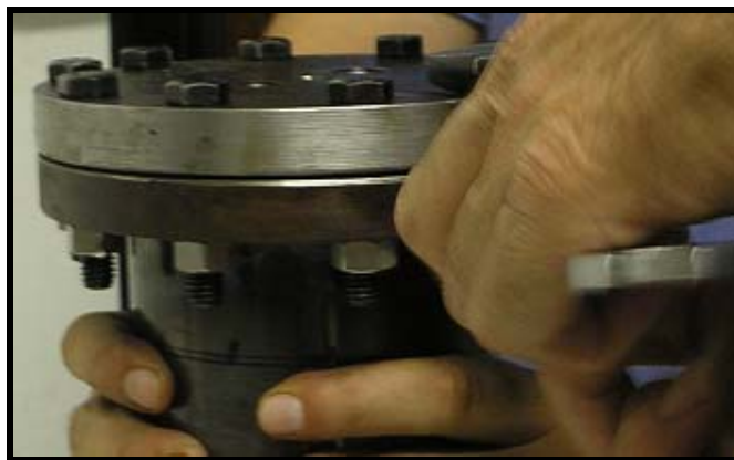
Figura 3.35: Fixação aparafusada das duas metades da tampa flangeada.
