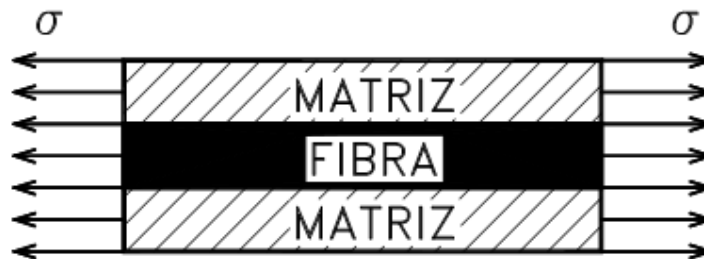
Figura 2.1: Composição do material compósito.
