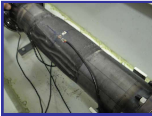
Figura 5.34: Strain gage localizado muito próximo ao enrugamento do reparo prejudicou os resultados dos primeiros ensaios com tubo reparado.
