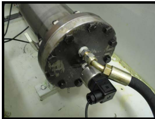
Figura 3.36: Detalhes da mangueira de aço e do transdutor.
