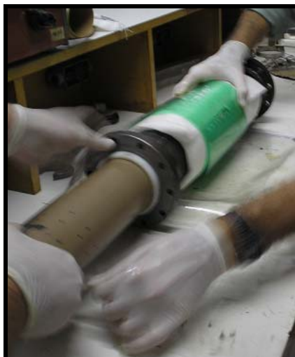
Figura 3.25: Colocação do tarugo de PVC no interior do tubo.
