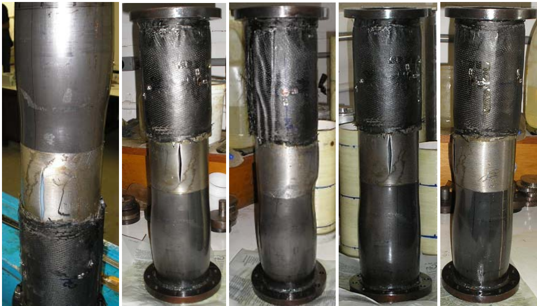
Figura 5.49: Análise completa das deformações ocorridas no tubo reparado após sua ruptura.
