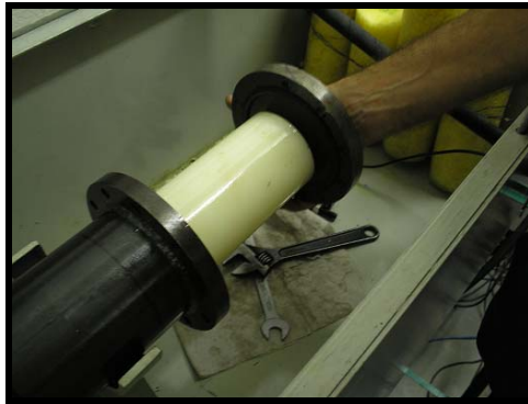
Figura 3.34: Colocação do tarugo de nylon no interior do tubo a ser ensaiado.
