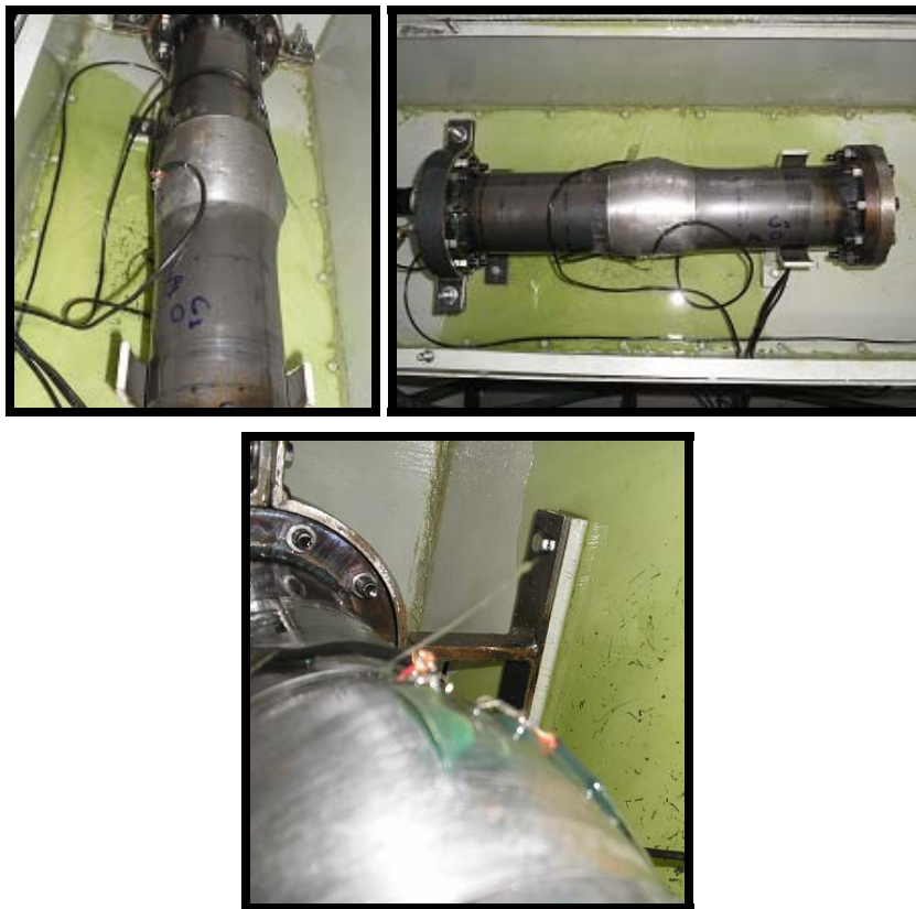
Figura 5.23: Análise do estufamento e ruptura do tubo em sua posição original de ensaio.
