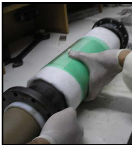
Figura 3.23: Colocação do PET ao redor do tubo.
