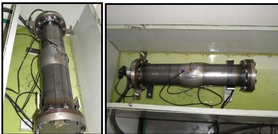
Figura 5.25: Situação do aparato experimental após a ruptura do tubo desbastado.
