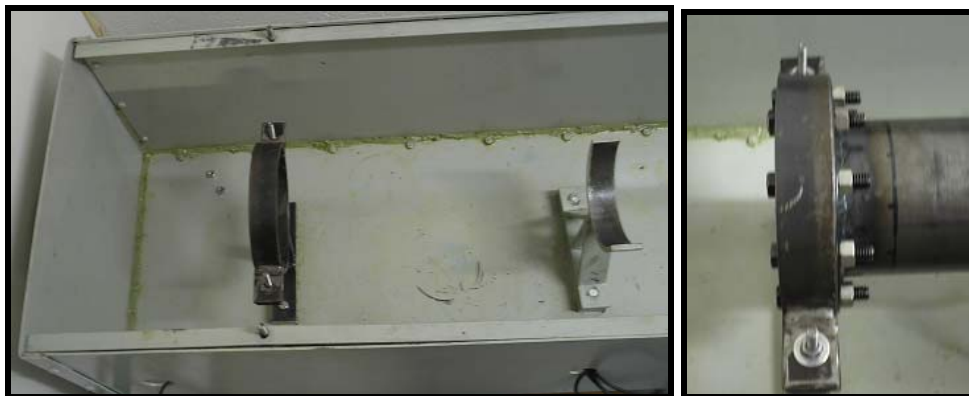
Figura 3.33: (a) Mancais de apoio do tubo de aço; (b) Mancal do engastamento do tubo na extremidade esquerda.
