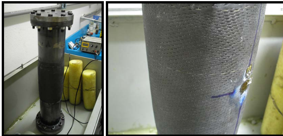
Figura 5.30: Preparação para o ensaio em regime elástico do tubo reparado.
