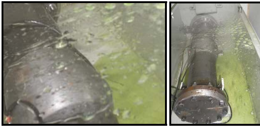
Figura 5.22: Momento da ruptura do tubo desbastado em sua região central.
