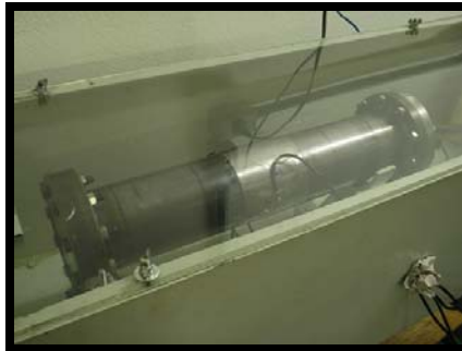
Figura 5.10: Início da pressurização do tubo desbastado e deformação plástica do tubo desbastado.
