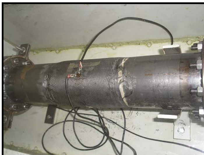
Figura 5.38: Preparação para o ensaio em regime de ruptura do tubo reparado. Aproximadamente para uma pressão de 50 bar, o tubo começa a estufar, principalmente na sua extremidade direita, próximo à tampa (Figs. 5.39).
