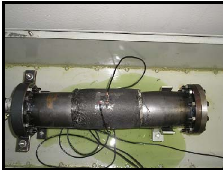
Figura 5.41: Momento do rompimento do tubo reparado.
