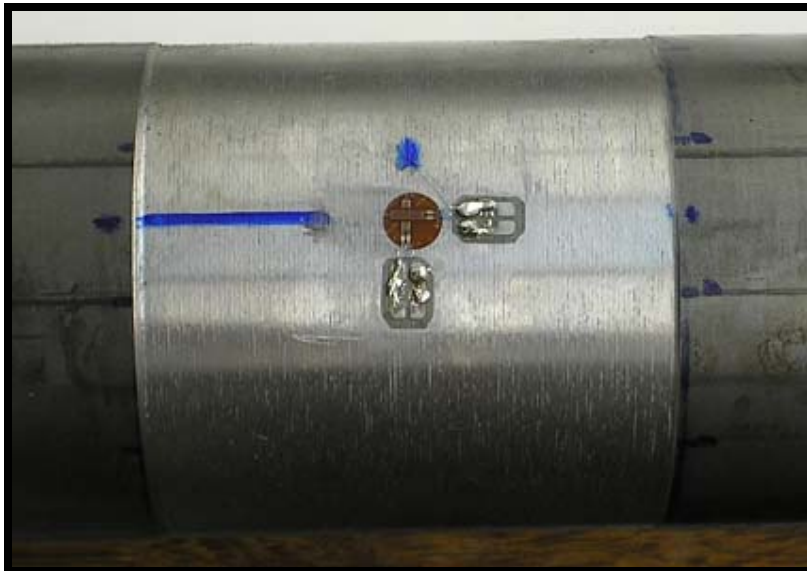
Figura 3.31: Corpo de prova instrumentado com extensômetro e conectores.
