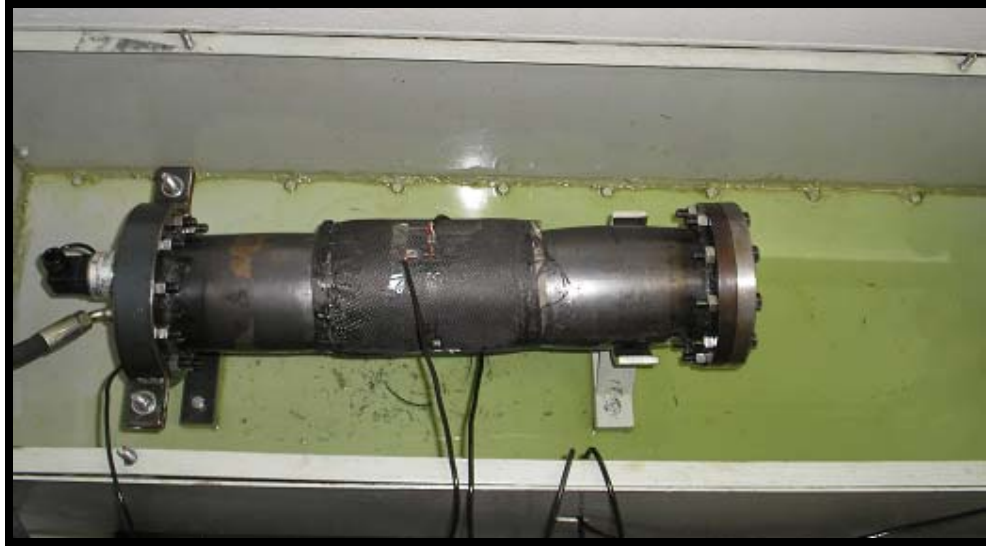
Figura 5.44: Situação do aparato experimental após o rompimento do tubo, onde se observa novamente a diferença de estufamento entre extremidade esquerda e direita do tubo.
