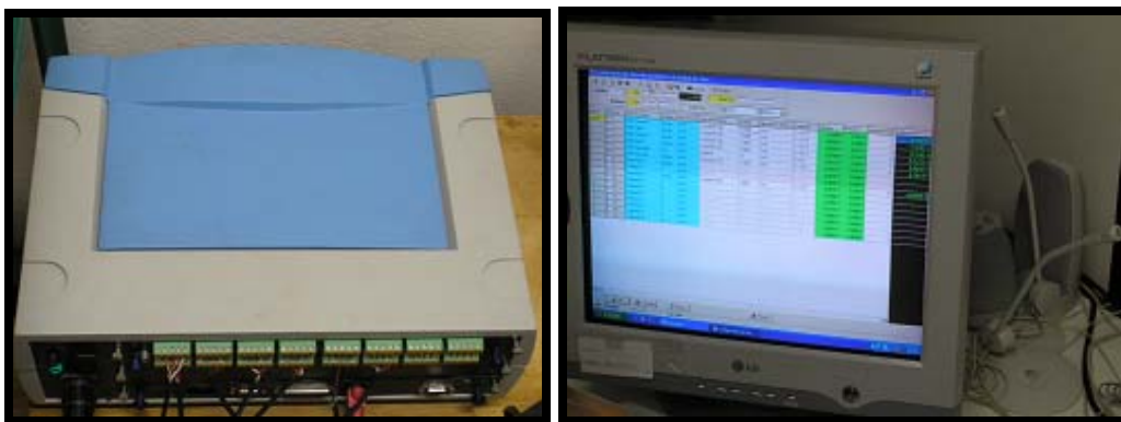
Figura 3.38: Sistema de Aquisição de Dados Lynx AqDados 7.02 ADS 2000.
