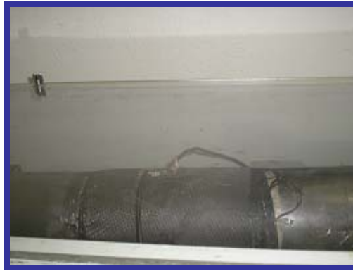
Figura 5.40: Início do ensaio experimental com tubo reparado e estufamento do tubo reparado em sua região central.
