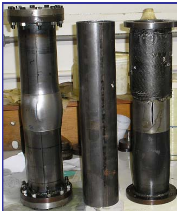
Figura 5.57: Ruptura no tubo reparado de aço 1010
