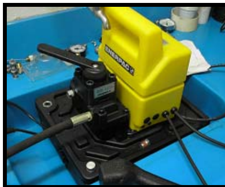
Figura 3.37: Sistema hidráulico de pressão (mangueiras, conexões e bomba hidráulica).
