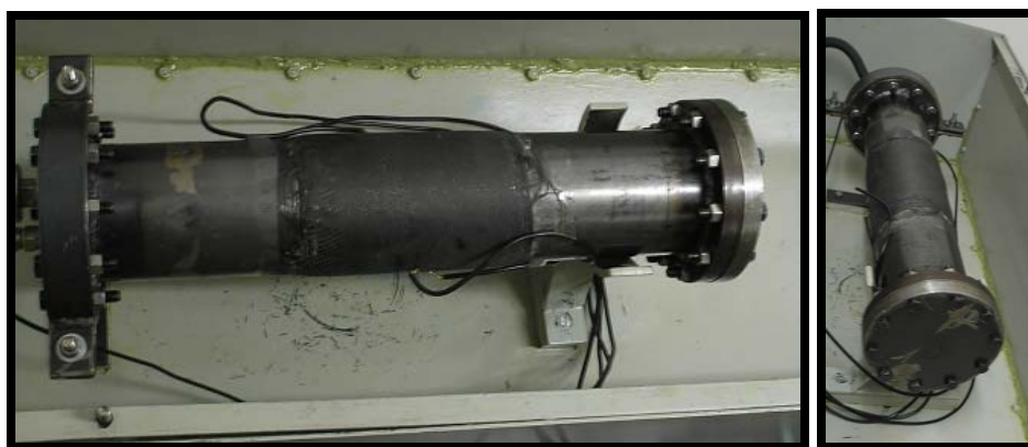
Figura 5.31: Tubo reparado sendo pressurizado em regime elástico.
