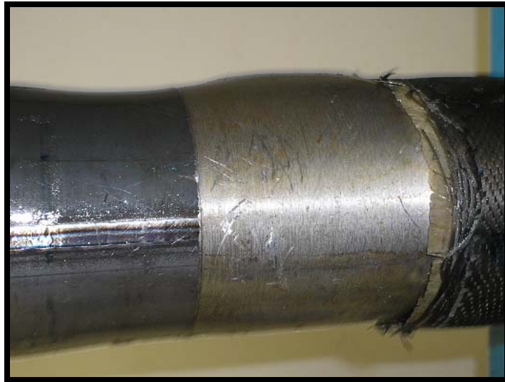
Figura 5.48: Deformação na região da costura praticamente nula, e à aproximadamente 90° da costura, um alto nível de estufamento na região desbastada e de estrangulamento na região onde se localizava a extremidade do reparo.
