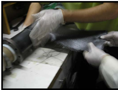
Figura 3.20: Colocação das camadas do laminado, uma a uma, ao redor do tubo.
