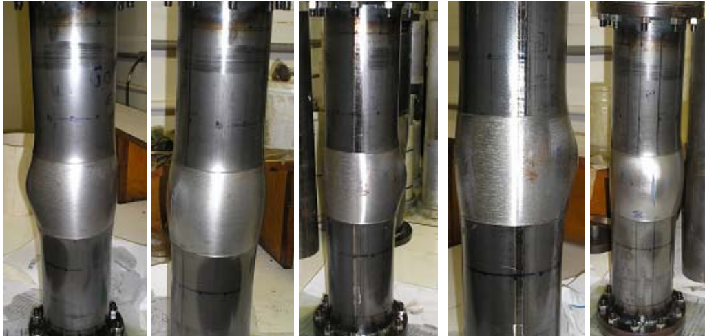
Figura 5.27: Análise completa das deformações ocorridas no tubo desbastado após sua ruptura.
