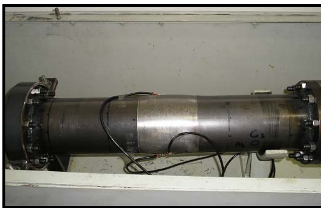
Figura 5.20: Preparação para o ensaio em regime de ruptura do tubo desbastado já deformado plasticamente.
