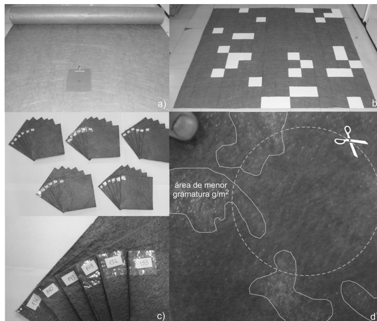
Figura 4.1 – Amostragem do geotêxtil: a) manta sobre uma superfície plana e limpa, b) recorde das amostras sorteadas, c) amostras identificadas e d) recorde da amostra em círculo.
