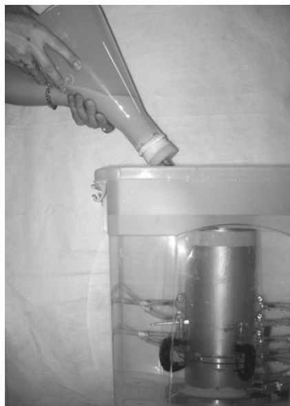
Figura 4.9 – Preparação da amostra de microesferas de vidro por meio da técnica da pluviação submersa.
