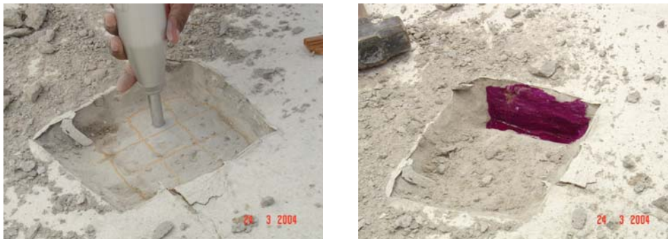
a) Esclerômetro em utilização no corte 1. b) Fenolftaleína utilizada no corte 1.
