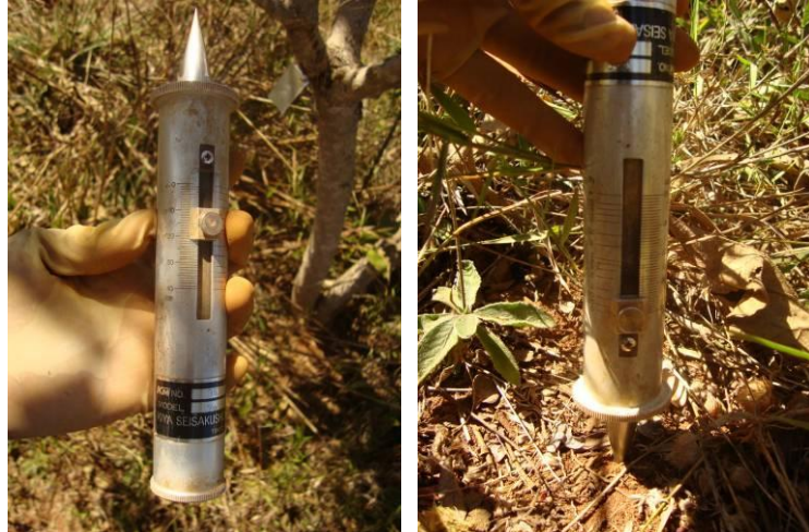
Figura 7. Penetrômetro dinamométrico de bolso, instrumento para mensuração da resistência à penetração na camada superficial do solo.
