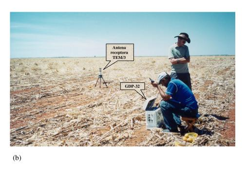
Figura 6.7 – Equipamentos utilizados na aquisição geofísica. (a) Sistema transmissor (GGT-10 e XMT-32); (b) Sistema receptor (antena TEM/3 e GDP-32).
