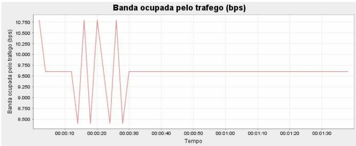
Figura 2.42 - Banda ocupada pelo tráfego de 8kbps na primeira fase do teste.
