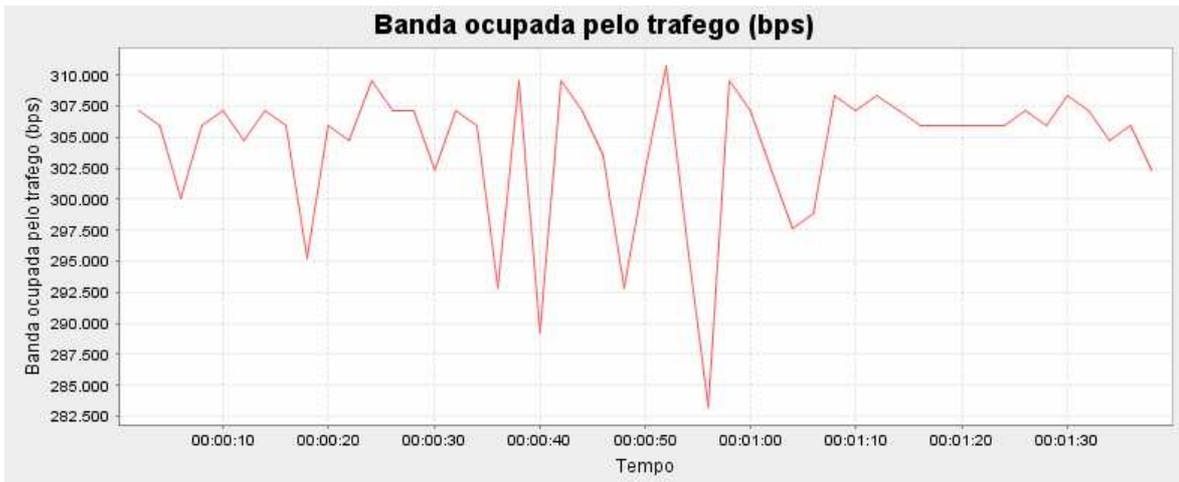
Figura 2.46 - Banda ocupada pelo tráfego de 256kbps na primeira fase do teste.
