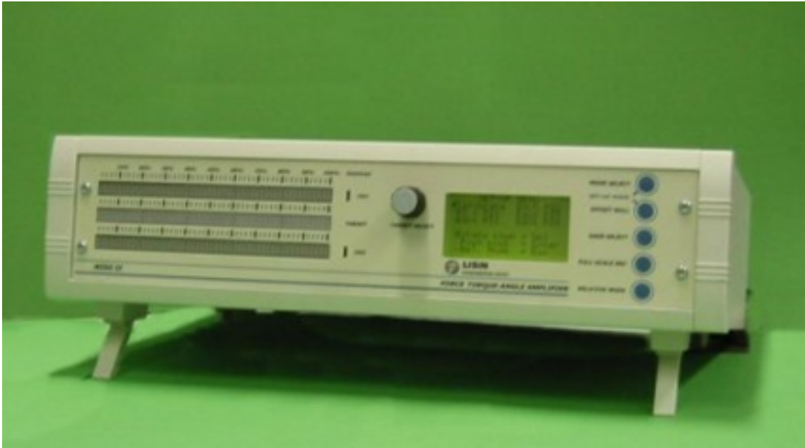
Figura 6: Amplificador de força com feedback visual intuitivo. (MISOII, LISiN Politecnico di Torino, Turim, Itália).
