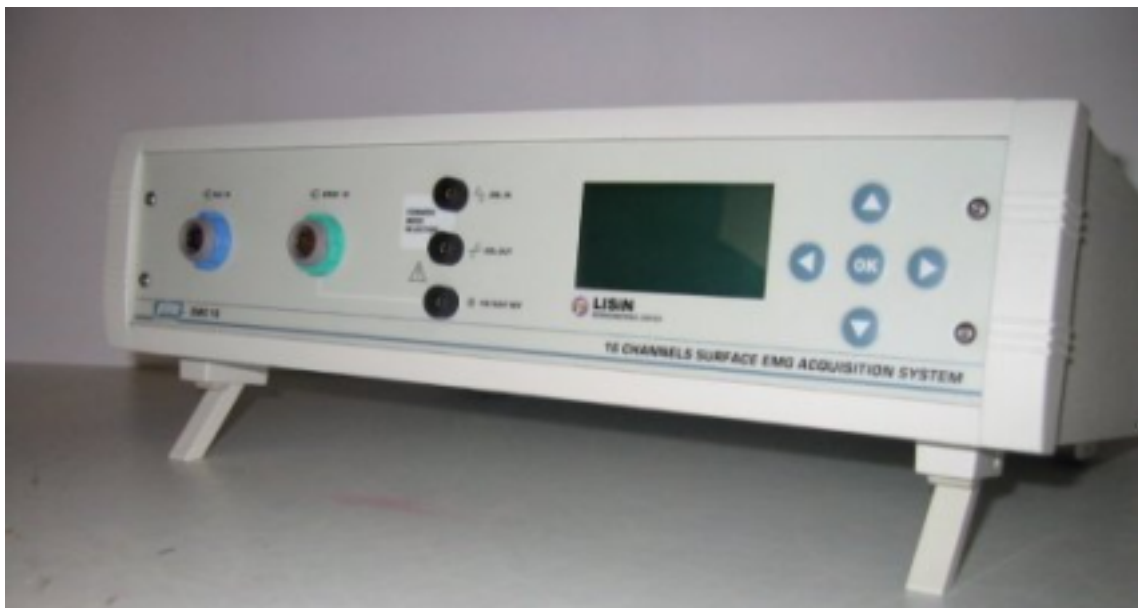
Figura 5: Eletromiógrafo de dezesseis canais com amplificação. (EMG-16, LISiN Politecnico di Torino — Ottino Bioelettronica, Rivaloro, Itália).
