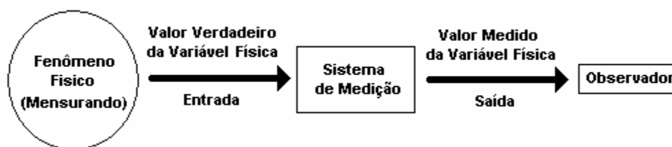
Figura 6.1 – Esquema genérico de um sistema de medição.
