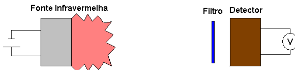
Figura 5.6 – Esquema de um transdutor de CO 2 , com os três principais componentes.
