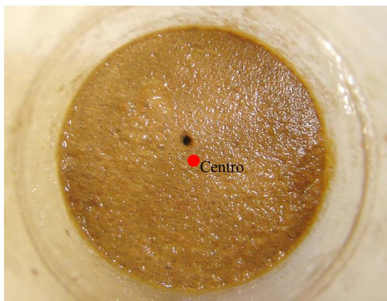
Figura 4.22 – Exemplo do Furo Não Centralizado Ocorrido no Ensaio E.
