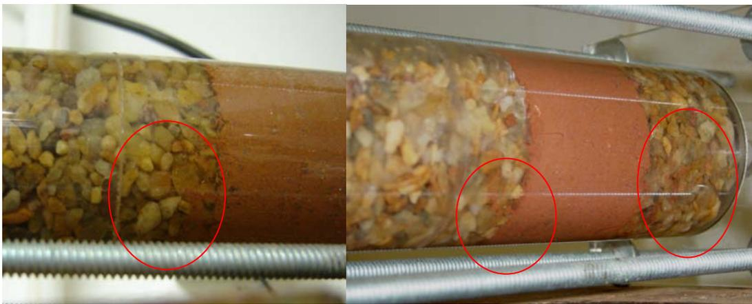
a) Presença de Partículas de Solo no Dreno Antes do Início do Ensaio (Ensaio D e E).
