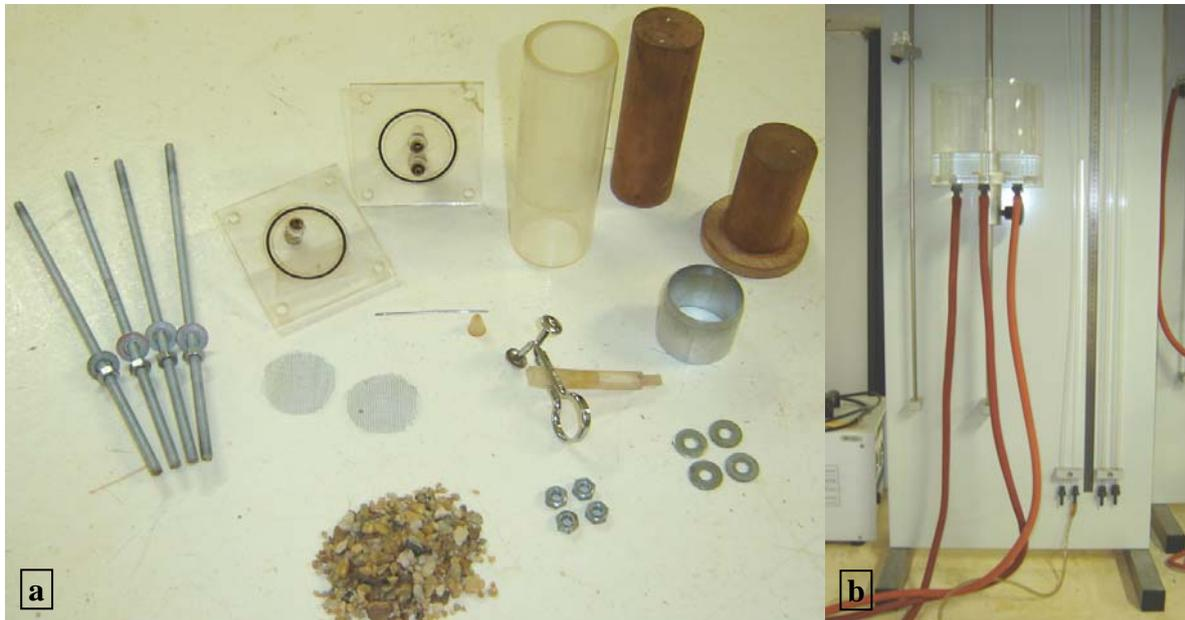
Figura 3.8 – Equipamentos para Ensaio Pinhole: a) Peças Componentes; b) Reservatório e Painel para Aplicação e Leitura das Cargas Hidráulicas.
