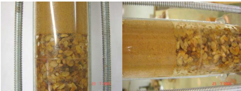
b) Presença de Partículas Finas no Dreno, Carreadas após Carga Hidráulica igual a 1080 mm.
