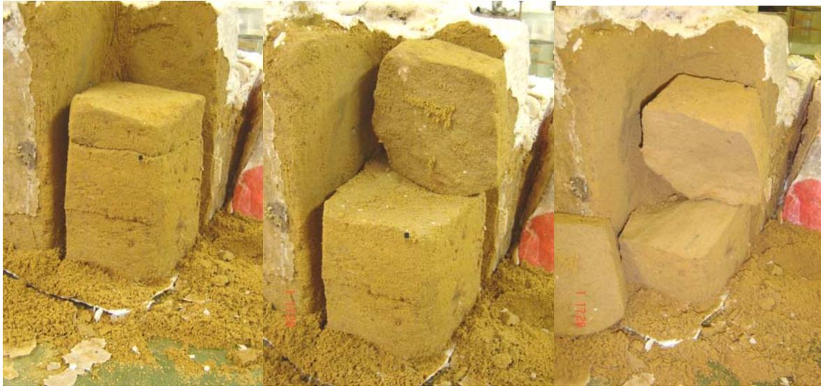
Figura 4.11 – Estratificação Observada no Bloco Indeformado.
