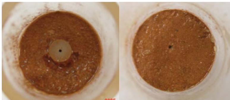
b) Deslocamentos ocorridos na face anterior ao furo (Ensaio B) e junto à parede do cilindro na face posterior do furo (Ensaio C).
