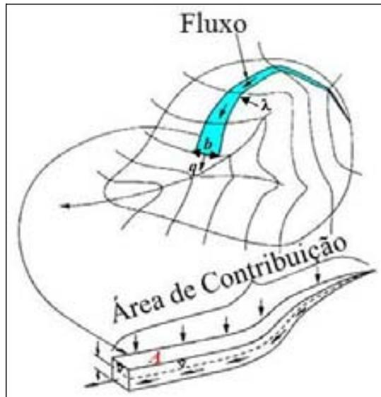
**Figura 5.5** – Diagrama de fluxo d'água em uma bacia parcial.  $A$  = área parcial da bacia;  $\lambda$  = comprimento parcial da bacia;  $b$  = largura do elemento de contorno e  $q$  = descarga por unidade de largura.
