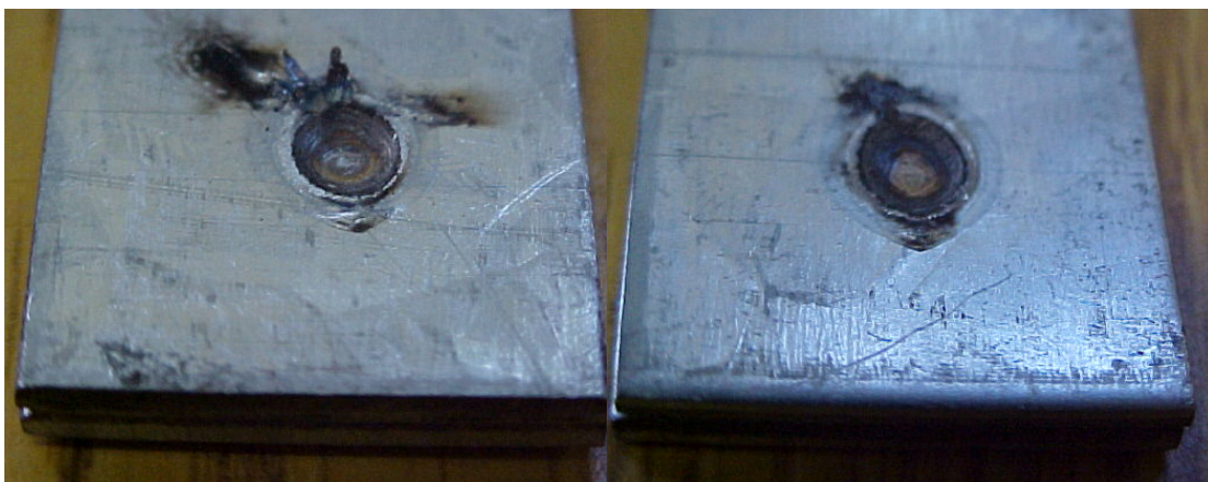
Figura 3.21 – Expulsão de material e exagerada indentação.
