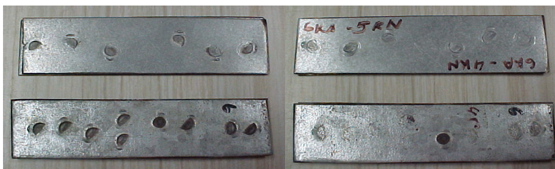
Figura 3.19 – Marcas deixadas pelo desalinhamento das pinças: a) Inferior e b) Superior.
