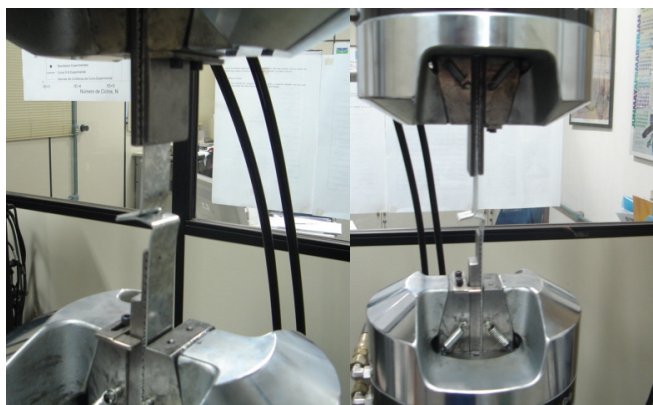
Figura 3.45 – Realização do ensaio de Tração/Rasgamento.
