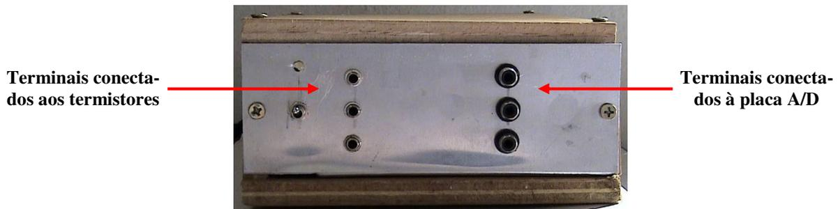
Figura 4.11 – Arranjo externo do circuito condicionador de sinais, exibindo o painel do equipamento.
