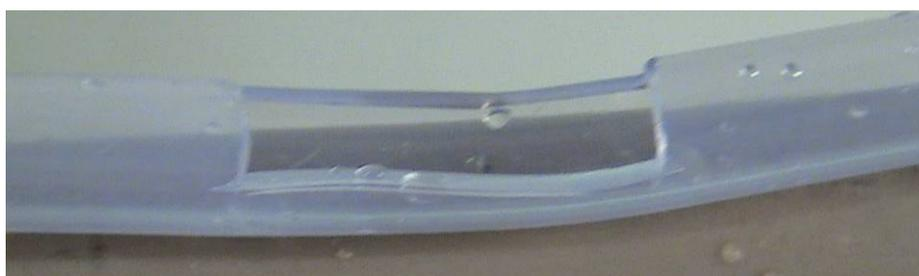
Figura 4.1 – Janela aberta no tubo de borracha utilizado nos experimentos.
