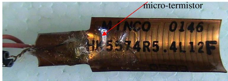
Figura 4.3 – Aquecedor flexível mostrando o micro-termistor aderido a sua face interna.
