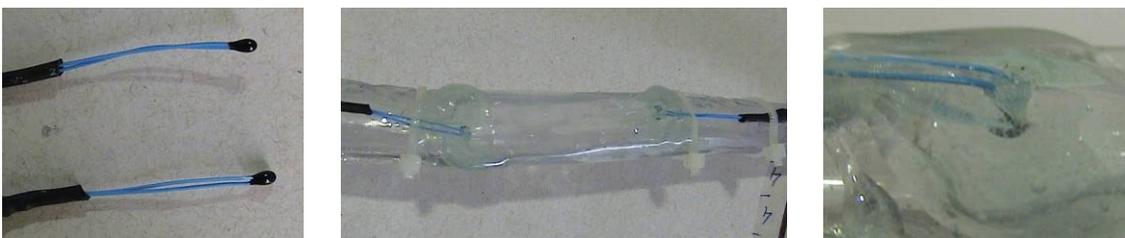
Figura 4.4 – Termistores utilizados na medição da temperatura do fluido.
