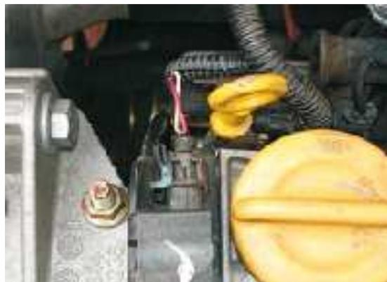
Figura 13.30 - Sensor de RPM.
