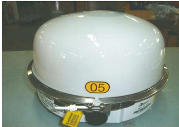
Figura 13.14 - Antena IMCT Banda Ku.
