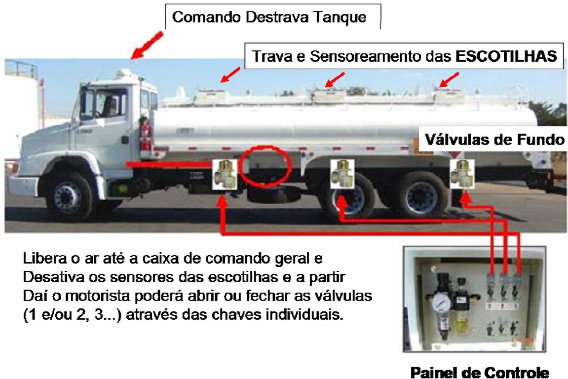
Figura 13.42 - Instalação painel controle, sensores/travas escotilhas/válvulas de fundo.
