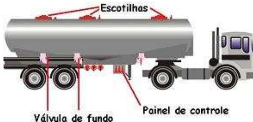
Figura 13.41 - Veículo tanque, painel de controle, escotilhas e válvulas de fundo.
