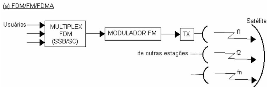
Figura 4.1 - Configurações de transmissões FDMA. (a) FDM/FM/FDMA [15].
