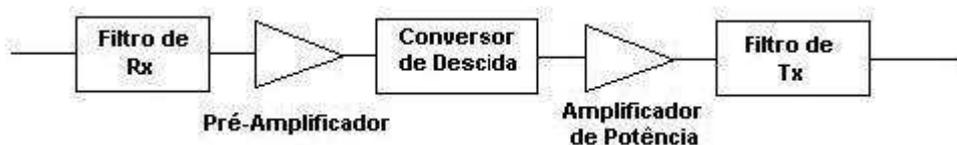
Figura 2.5 - Diagrama em bloco básicos de um *transponder* [5].
