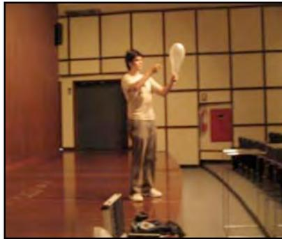
Figura 38 - STJ. Procedimento de medição de tempo de reverberação.
