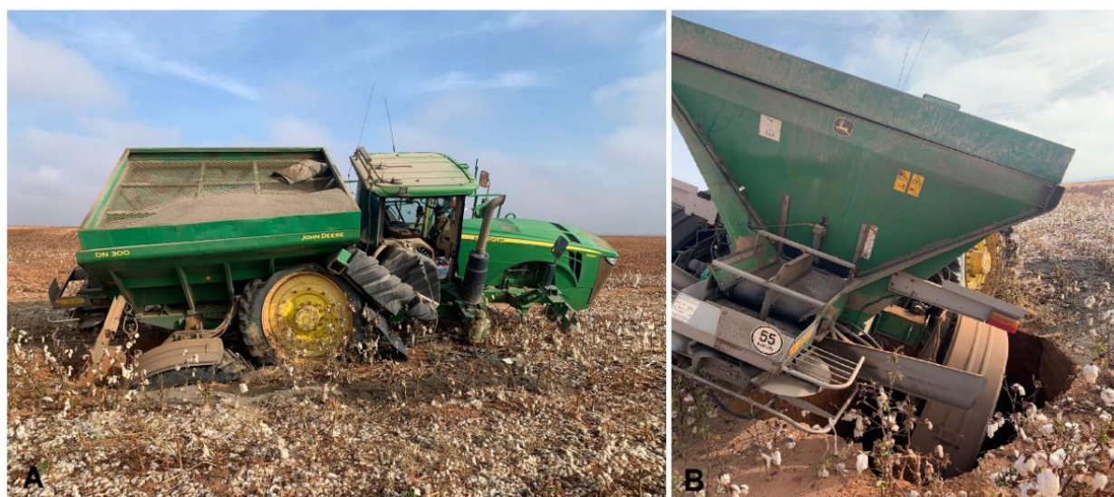
Figura 5.9. Avarias provocadas a máquina agrícola Dry Box pela queda em abatimento (E374463,32 m e N8688784,59 m) ocorrido em área agrícola da Fazenda Orquídea na região de Placas em novembro de 2021 (Imagens cedidas por: David Schmidt).
