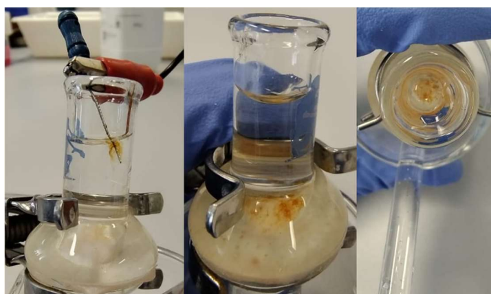
Figura 35. Oxidação do eletrodo de aço inoxidável na presença de tampão HEPES.
