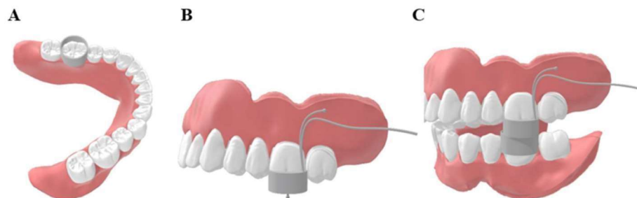
Figura 28. Dispositivo para aplicação de iontoforese durante tratamento endodôntico. (A) Reservatório do fármaco. (B) Peça complementar acoplando os eletrodos. (C) Representação do modelo com a mordida do paciente.
