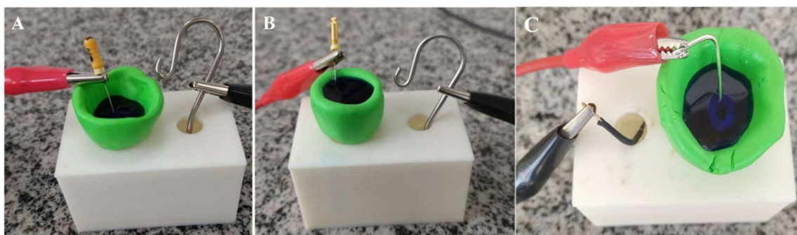
Figura 18. Aplicação da iontoforese com o modelo bicompartimental personalizado, utilizando (A) lima de aço inoxidável, (B) lima de níquel-titânio com gancho localizador apical como eletrodo de retorno e (C) fio de prata pura com AgCl como eletrodo de retorno.
