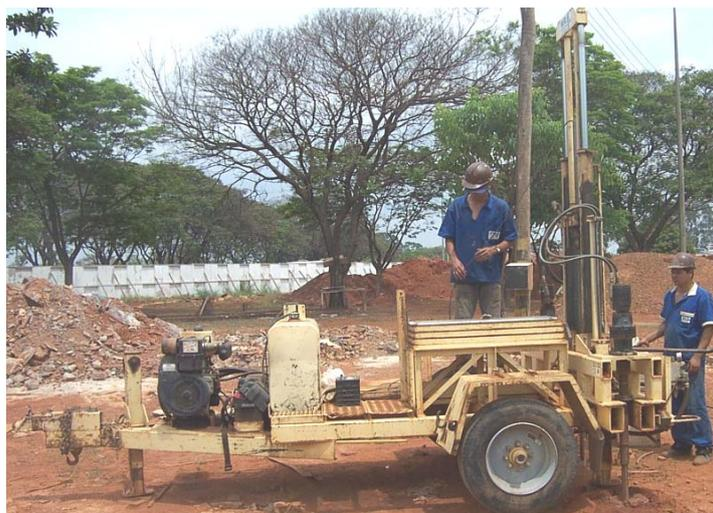
Figura 3.29 Vista do equipamento de CPT
