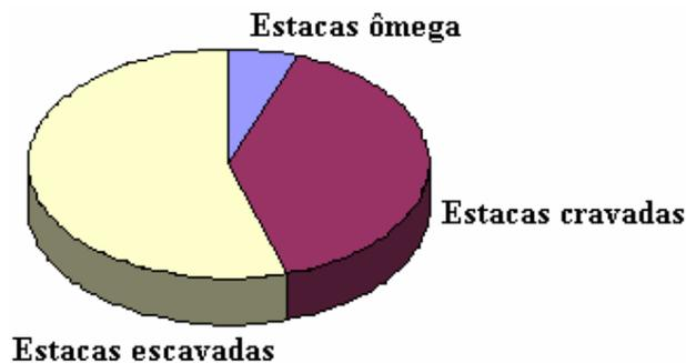
Figura 2.1 Estimativa do uso de estacas no mundo (Van Impe, 2003).
