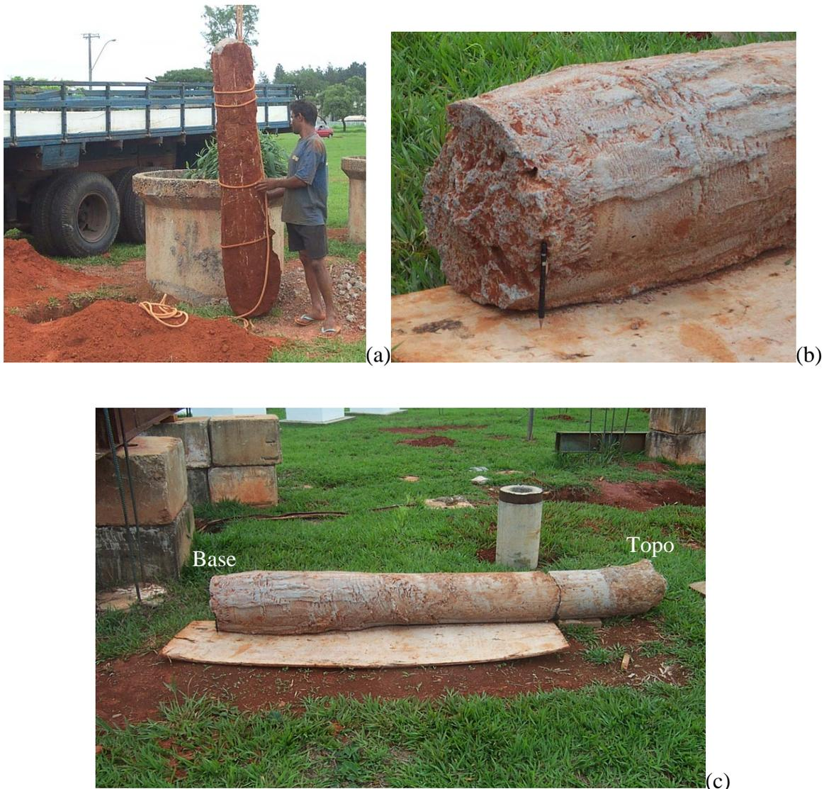
Figura 3.25 Estaca hélice contínua exumada
