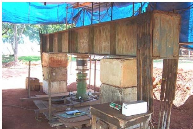
Figura 3.53 Prova de carga no tubulão  $T_{CC\text{B1}}$  – Efetividade da reação
