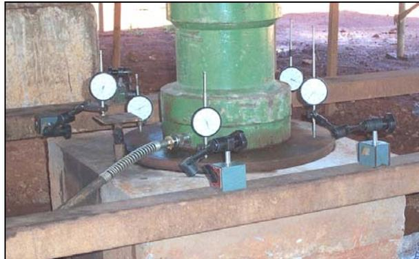
Figura 3.51 Prova de carga em andamento no tubulão  $T_{CC\text{FB}}$
