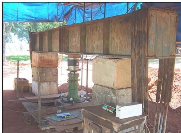
Figura 3.52 Prova de carga no tubulão  $T_{CC\text{B1}}$
