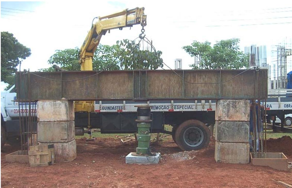
Figura 3.38 Montagem do sistema de reação para a prova de carga na estaca escavada
