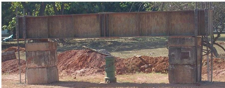
Figura 3.19 Tubulão preparado para a prova de carga
