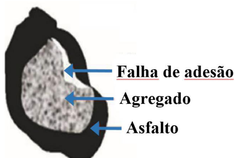
Figura 1-2 Dano na interface entre asfalto e agregado (Guo, 2016).
