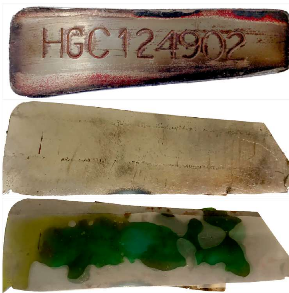
Figura 41 – Imagem fotográfica da placa NIV 01 durante o processo de aplicação do filme polimérico
