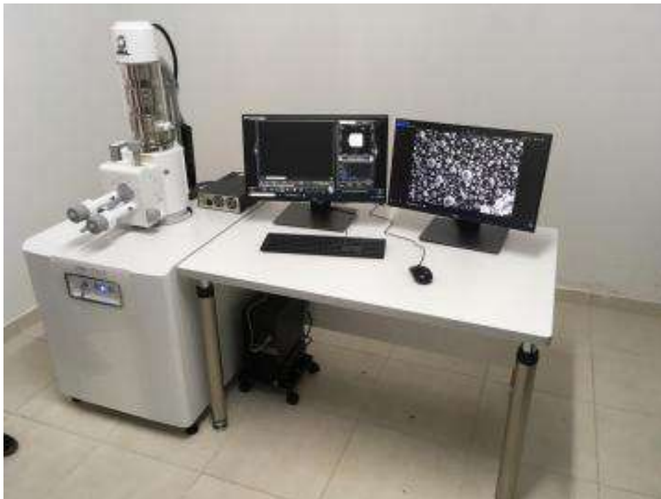
Figura 4 – Ensaio microscópico através de microscopia eletrônica de varredura (MEV)
