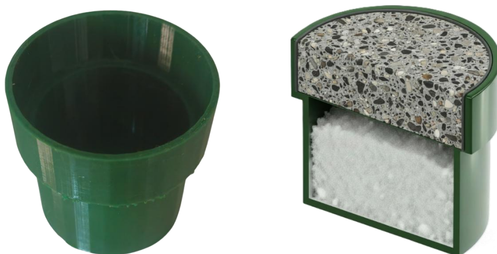
Figura 60 – Recipiente em plástico impresso em 3D para realização do ensaio de permeância ao vapor à esquerda e representação realista de corte da amostra à direita.
