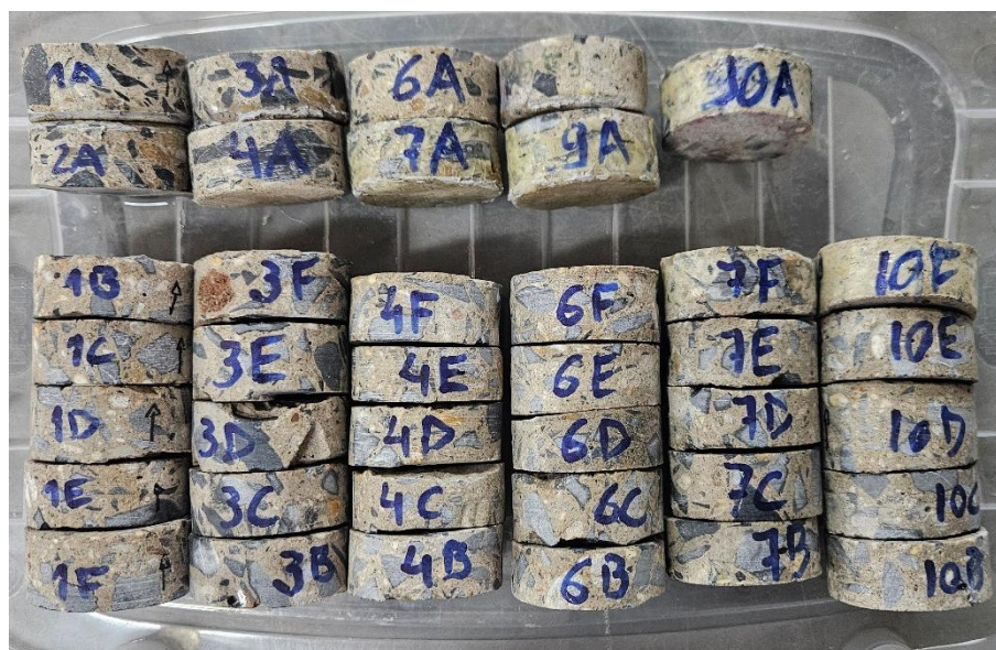
Figura 73 – Amostras sem alteração de coloração após aplicação de solução de fenolftaleína.
