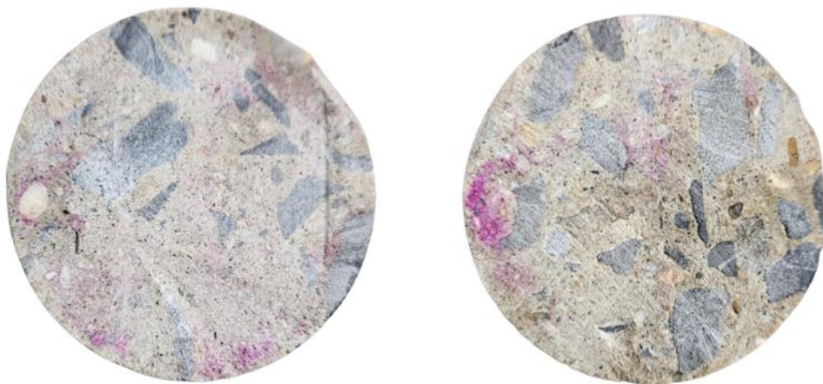
Figura 74 – Pontos esparsos de coloração rosada nas amostras indicando áreas não carbonatadas.
