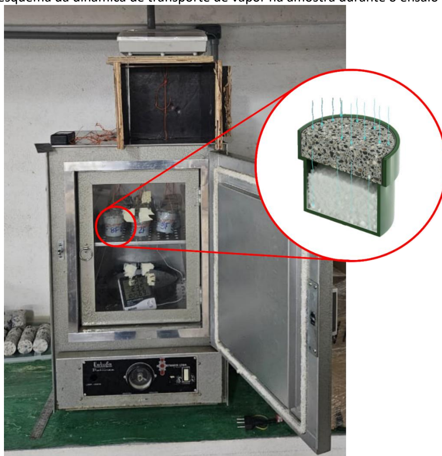
Figura 61 – Câmara de ensaio de permeância ao vapor, a partir da adaptação de uma estufa. Em destaque, esquema da dinâmica de transporte de vapor na amostra durante o ensaio de copo seco.
