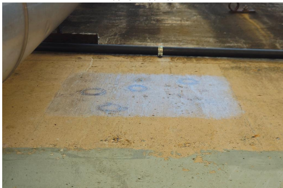
Figura 77 - Área 01 de ensaio de absorção de água com tubos Karsten passado o tempo de secagem do verniz acrílico.
