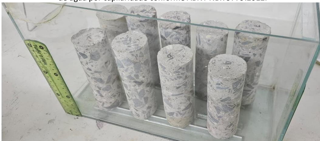
Figura 57 – Disposição dos testemunhos dentro do recipiente para realização do ensaio de absorção de água por capilaridade conforme ABNT NBR 9779:2012.
