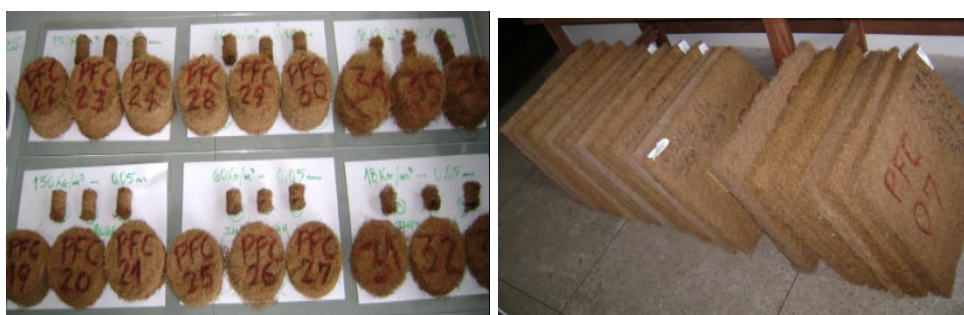
(b) (b) Figura 11 - Amostras de fibra de coco: (a) para ensaio no tubo de impedância (b) para ensaio na minicâmara reverberante (VIEIRA, 2008).
