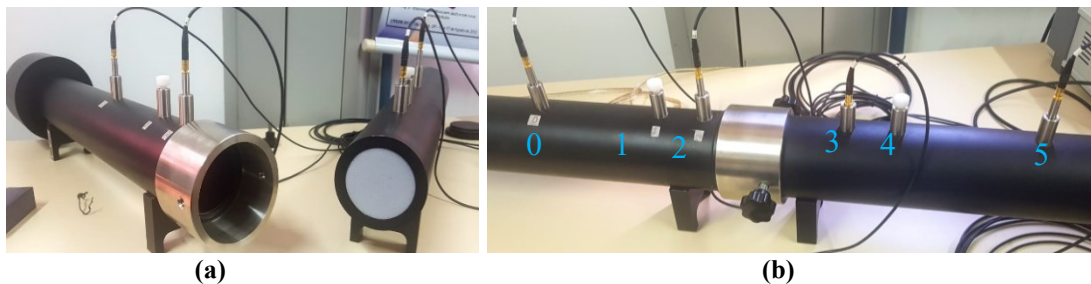
Figura 67 - Procedimento pr vio  s medi  es: (a) inser   o da amostra no tubo (b) acoplamento dos tubos e verifica   o da posi    o dos microfones.
