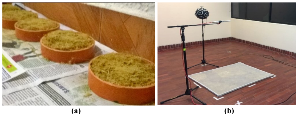
Figura 9 - Amostras de fibra de bambu: (a) para ensaio no tubo de impedância (b) ensaio na câmara reverberante (PÁEZ et al. , 2007).
