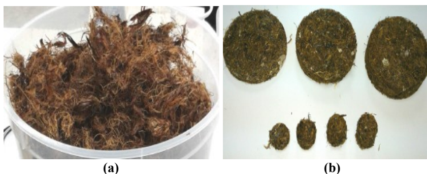
Figura 27 -- Mesocarpo da Palmeira: (a) fibra (b) amostra construída a partir da fibra (LATIF et al. , 2015).
