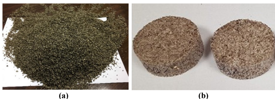
Figura 28 - Polpa de beterraba desidratada: (a) partículas entre 8 a 10 mm (b) amostra confeccionada com as partículas e amido de batata (KARAKY et al. , 2019).
