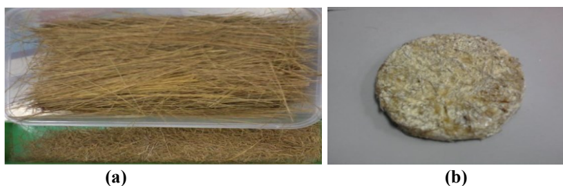
Figura 17 - Palha seca: (a) fibra (b) amostra construída a partir da fibra (ABDULHAH et al. , 2011).
