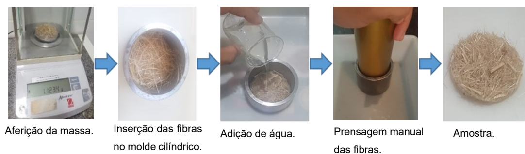
Figura 46 - Processo de fabricação das amostras A
