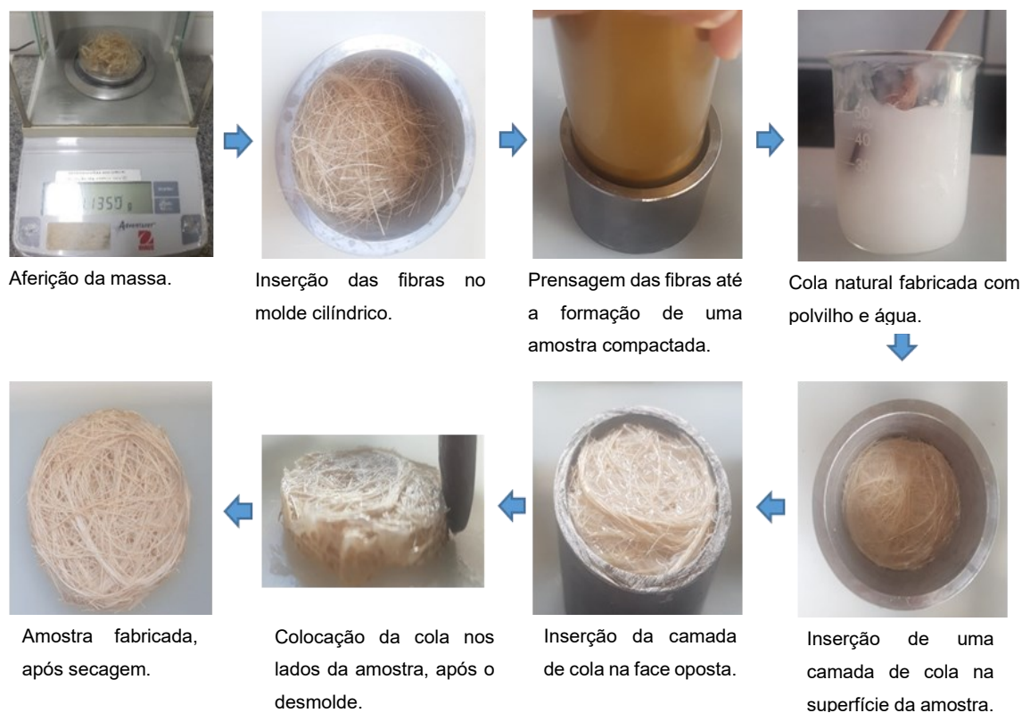
Figura 51 - Processo de fabricação das amostras C.
