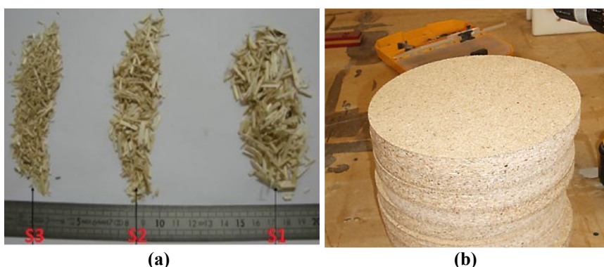
Figura 14 - Canhamo: (a) diferentes espessuras estudadas por Glé et al. (2011) (b) amostras para o ensaio no tubo de impedância confeccionada por Saad e Kamal (2013).
