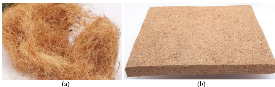
Figura 2 – Coco: (a) fibra (b) placa de absorção acústica desenvolvida com a fibra (COQUIM, 2019).
