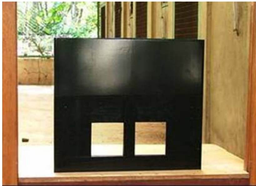
Figura 9: Vista frontal do suporte de acrílico. As aberturas em forma de quadrados nas janelas são para que os animais possam visualizar a figura da prancha do HRR.
