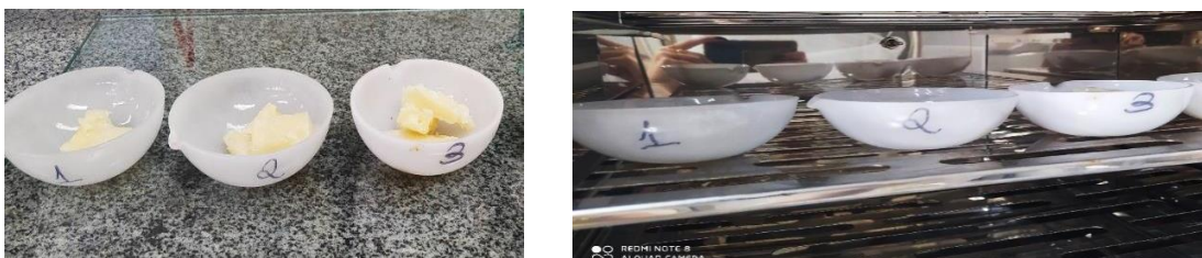
Figura 8. Fotografias ilustrativas do teste de umidade da base saponéica. Fonte: Autora, 2023.
