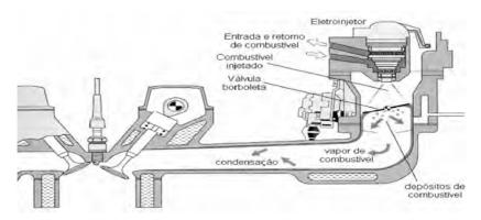
Figura 43 – Sistema mono ponto e fenômeno da condensação com motor frio – (BOSCH, 1999).
