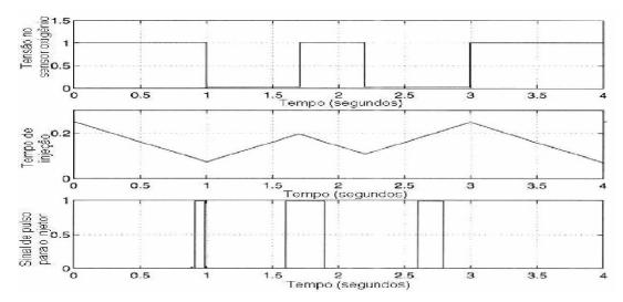
Figura 41 – Formas de onda simplificadas em um sistema de controle de combustível em malha fechada – (RIBBENS, 2003)
