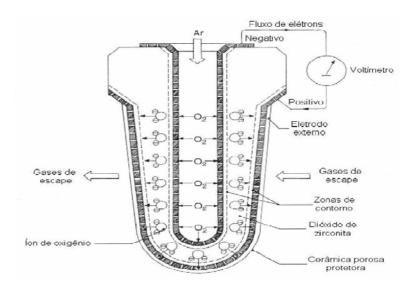
Figura 54 – Princípio de funcionamento do sensor de oxigênio.
