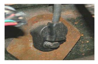
Figura 34 – Sensor de fase do motor
