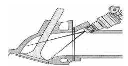
Figura 42 – Formação da mistura e posicionamento dos injetores em sistemas multiponto (BOSCH, 1999)
