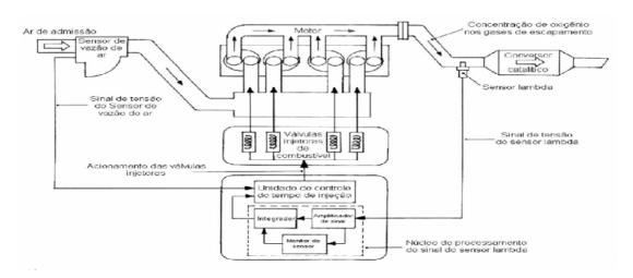
Figura 55 – Controle do motor em malha fechada monitorando o sensor lambda.
