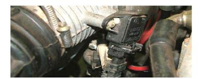
Figura 38 – Potenciômetro sensor da posição da borboleta de aceleração
