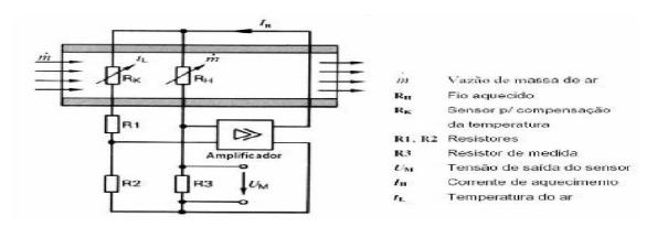
Figura 32 - Circuito elétrico do sensor de vazão mássica
