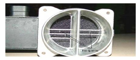
Figura 31 - Sensor de vazão mássica
