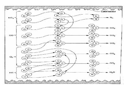
Figura 50 – Reações químicas que ocorrem em um conversor catalítico, (HEISLER, 2002)
