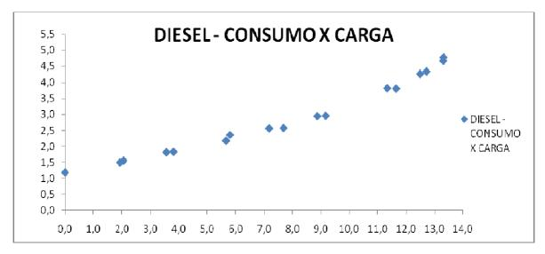
Figura 59 – Consumo kg/h x carga aplicada kW- Diesel.
