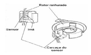
Figura 36 – Funcionamento do sensor de fase – (DENTON, 2000)
