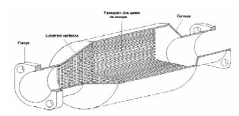
Figura 51- Aspecto interno de um conversor catalítico.
