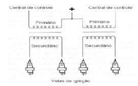
Figura 48 – Funcionamento da Ignição DIS com bobina dupla, centelha perdida.
