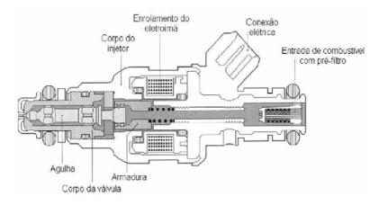
Figura 44 – Injetor típico e suas partes internas – (BOSCH, 1999)
