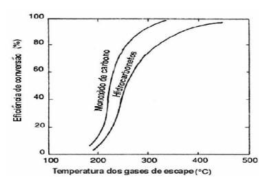
Figura 52 – Eficiência do conversor catalítico versus temperatura de operação.
