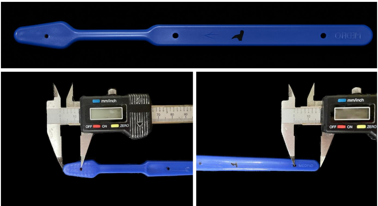
Figura 5 - Escovas de dente MedFio devidamente enumeradas e com três marcações definidas. Uma marcação no centro geométrico da cabeça da escova para delimitar o posicionamento centralizado em relação à superfície das amostras. Enquanto as outras duas demarcações na haste sinalizavam a posição definida para o rosqueamento das escovas de dente nas estações do simulador de ensaio abrasivo.
