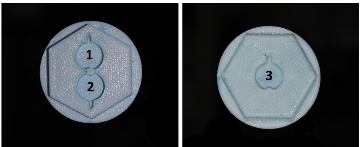
Figura 4 - Receptáculos fabricados em material sintético de PLA. Dois receptáculos diferentes foram confeccionados buscando avaliar a influência da posição da amostra frente à escova de dente durante o ensaio de abrasão. O receptáculo do tipo duplo permitiu o encaixe de 2 amostras em seus dois nichos, assim, sendo possível escovar duas amostras simultaneamente em uma posição posterior (posição 1) e anterior (posição 2) à escova de dente. Já o receptáculo do tipo único permitiu o encaixe de somente
