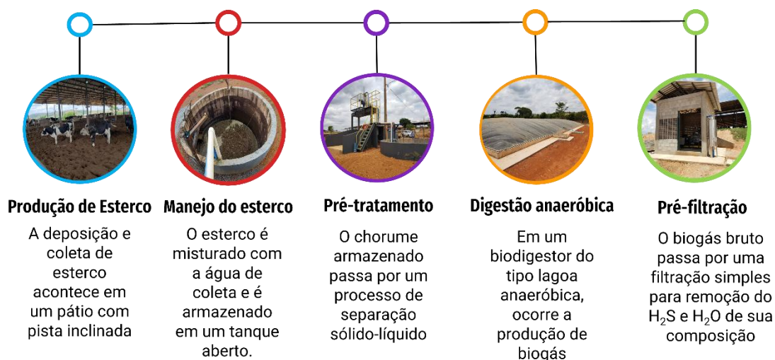
Figura 8 - Fronteiras do sistema de fase de produção para 1 MJ de biogás bruto.
