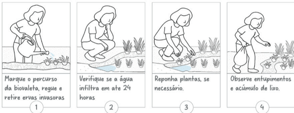
Figura 128: Manutenção de um jardim de chuva
