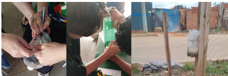
Figura 158: Montagem dos PluviPETs e exemplo de um dispositivo instalado
