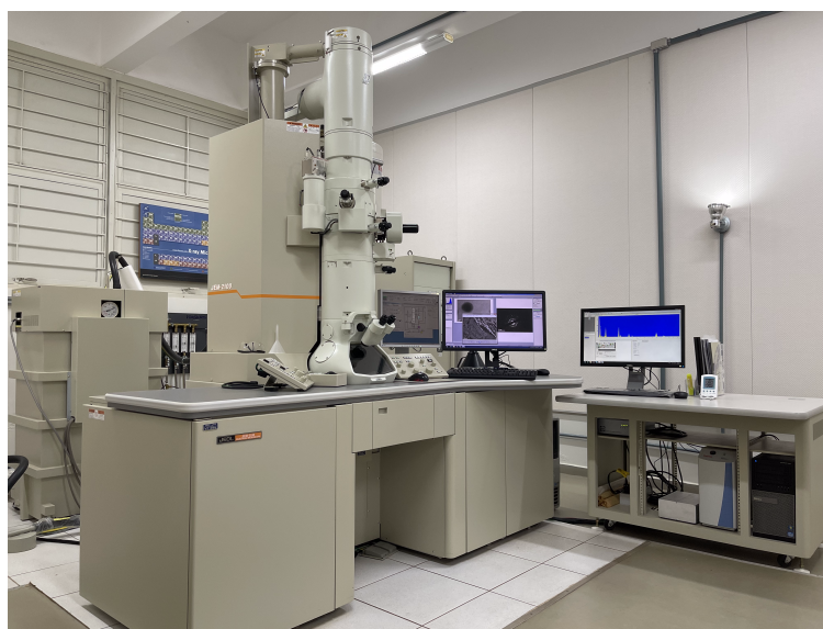
Figura 16 – Microscópio Eletrônico de Transmissão (MET), JEM-2100, Jeol. LAbMic - Universidade Federal do Goiás (imagem retirada do sítio eletrônico do laboratório).
