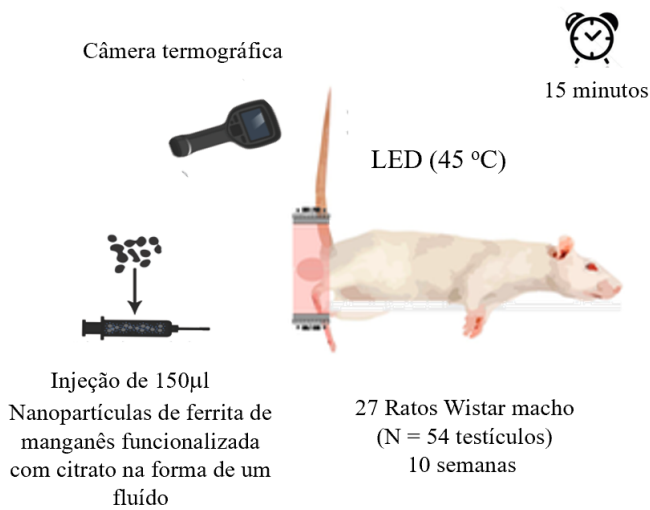
Figura 40: Desenho experimental do método de fotohipertermia com o equipamento projetado com 2 LEDs.
