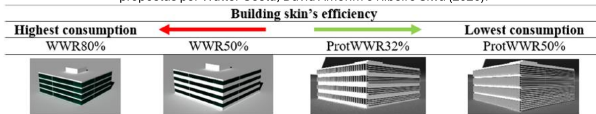
Figura 2.2: Representação do modelo de edifício com as diferentes proporções de PAF e proteção solar propostas por Walter Costa, David Amorim e Ribeiro Silva (2020).
