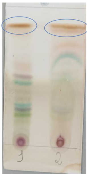
Figura 6. Cromatograma em camada delgada (CCD) dos extratos orgânicos da cultura de Sanionia uncinata . A placa de sílica gel foi desenvolvida utilizando hexano:acetona (80:20 v/v) como fase móvel, e revelada por imersão em solução de oleum seguida de aquecimento. Pista 1: extrato de acetona da cultura de Sanionia uncinata . Pista 2: extrato de acetato de etila da cultura de Sanionia uncinata .
