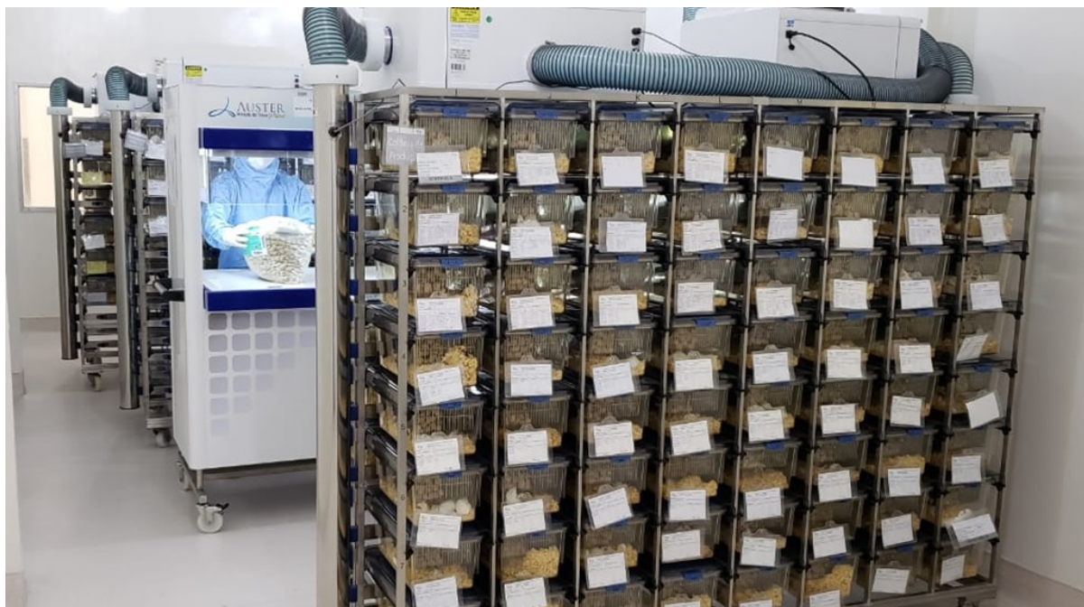
Figura 3 - Biotério de criação do Instituto de Ciência e Tecnologia em Biomodelos (ICTB), Fiocruz. Racks tipo IVC e animais dentro de micro-isoladores (gaiolas). Ao fundo, o técnico em manejo de animais está paramentado com EPIs. Ele abre o saco de ração estéril em um módulo de troca . Foto: Dra. Isabel Freire (ICTB/Fiocruz).
