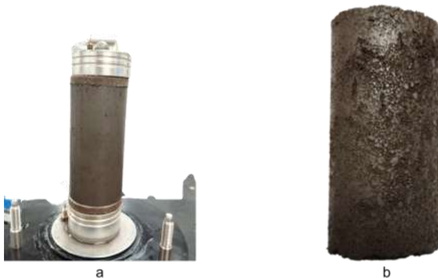
Figura 3.5: Ilustração de corpos de prova moldados para os Ensaios Triaxiais: a) Amostra moldada com Energia Proctor Normal; b) Amostra fofa.
