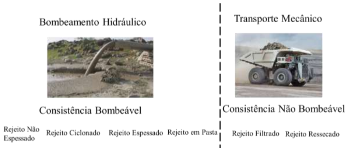
Figura 2.2: Relação de Técnica de Transporte de Rejeito com a Consistência do Rejeito. (Adaptado de GOLDER, 2015)
