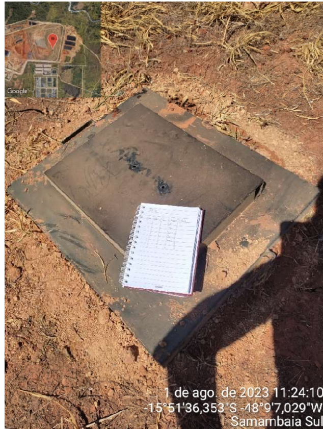
Figura 4.8 - Ensaio da placa de fluxo realizado no ASB
