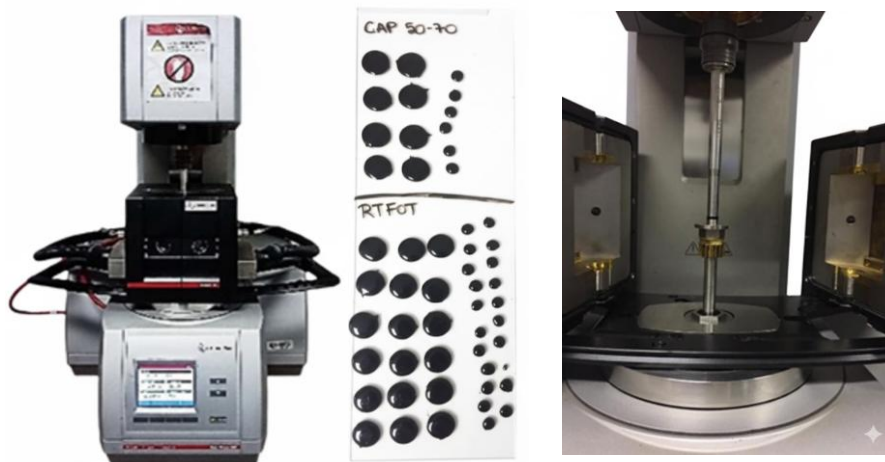
Figura 3.11 – Reômetro para ensaios de caracterização reológica; Amostras com 8 e 25 mm de diâmetro; conjunto de placas paralelas.
