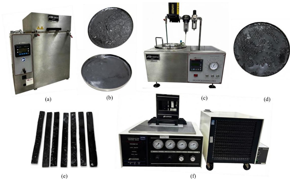
Figura 3.13 – (a) Estufa PAV- Vaso de Envelhecimento sob Pressão. (b) amostra de ligante aerada. (c) Estufa a vácuo. (d) amostra de ligante desareada. (e) Amostra de ligante para ensaio de viga. (f) Equipamento BBR.
