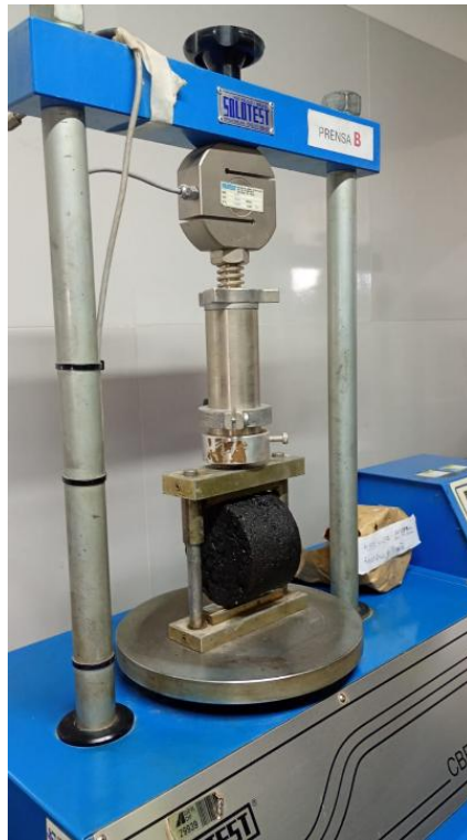
Figura 3.22. Prensa usada nos ensaios de resistência à tração.
