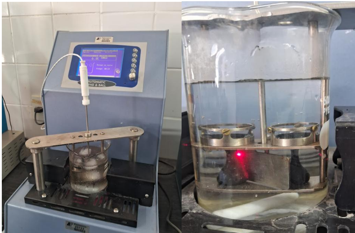
Figura 3.14. Equipamento de anel e bola automático usado no ensaio.
