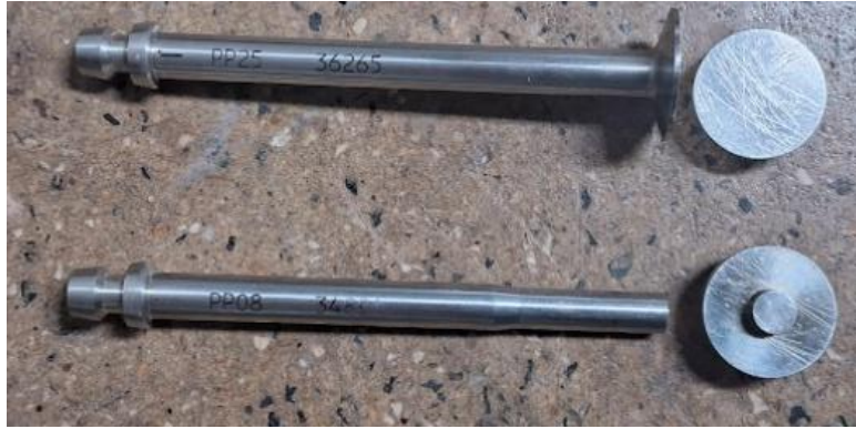
Figura 3.18. Placas de 25 mm e de 8 mm usadas no reômetro da Anton Paar .
