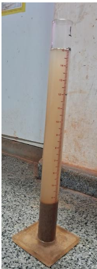
Figura 3.12. Realização do ensaio de equivalente de areia.
