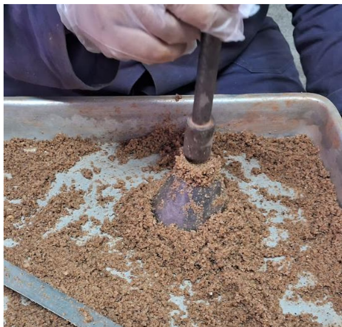
Figura 3.9. Teste na areia para confirmar se o agregado chegou a condição de superfície saturado seca.
