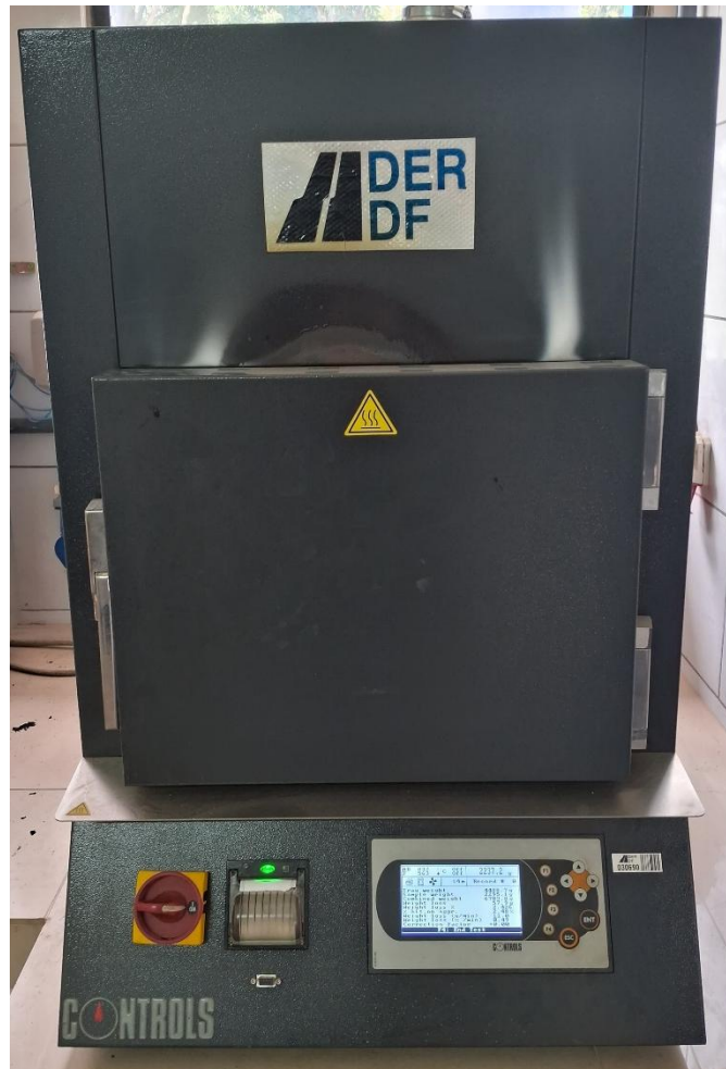
Figura 3.6. Forno usado para queimar o asfalto das misturas estudadas.
