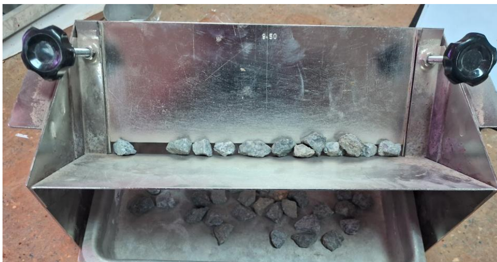
Figura 3.7. Uso do crivo para execução do ensaio de índice de forma.
