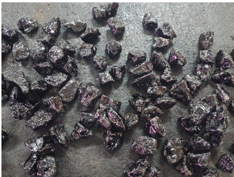
Figura 4.3. Resultado do ensaio de adesividade do agregado mineral
