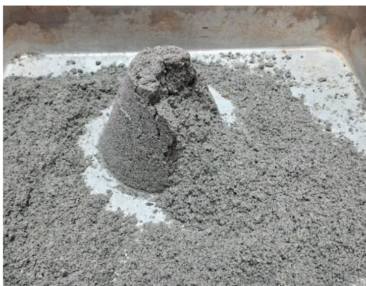
Figura 3.9. Teste na areia para confirmar se o agregado chegou a condição de superfície saturado seca.
