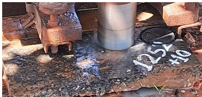
Figura 3.5. Extração de CP com a broca. (Fonte: Autor)
