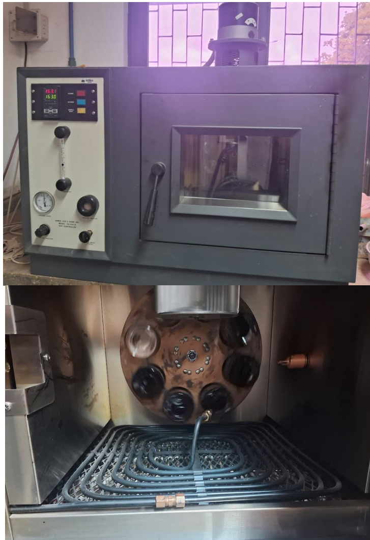
Figura 3.20. Exterior e interior de um forno para ensaio de RTFOT.
