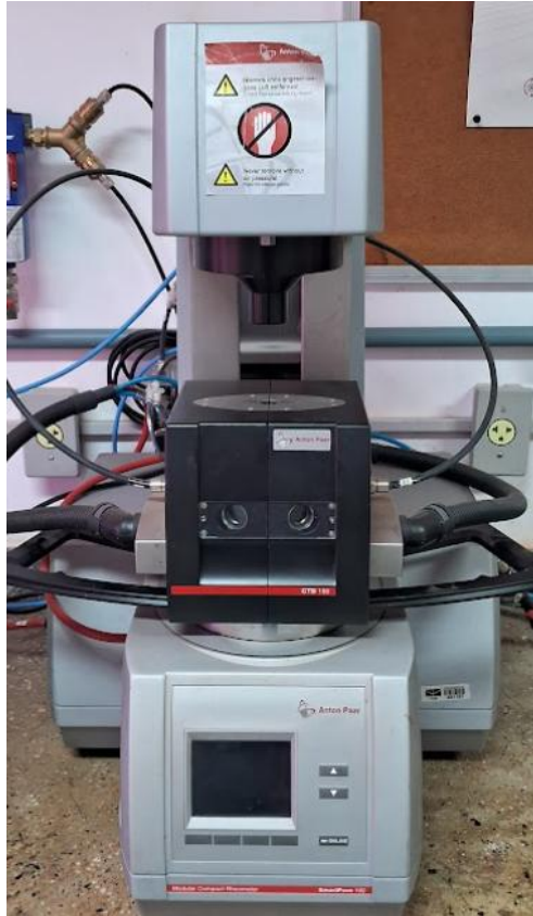
Figura 3.16. Reômetro de cisalhamento dinâmico usado na pesquisa.
