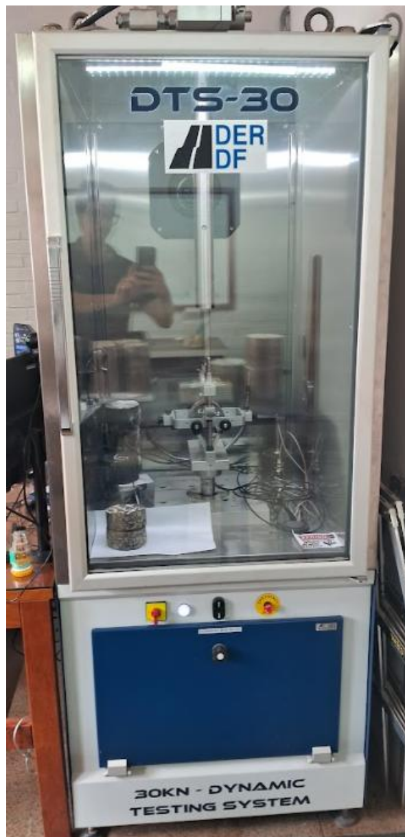
Figura 3.23. Equipamento utilizado para os ensaios de módulo de resiliência e vida de fadiga.
