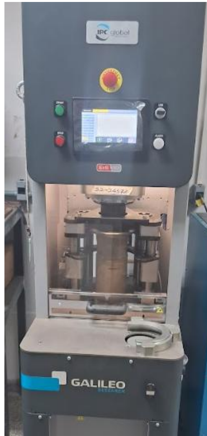
Figura 3.21. Compactador giratório usado para confecção dos corpos de prova de ambas as misturas.
