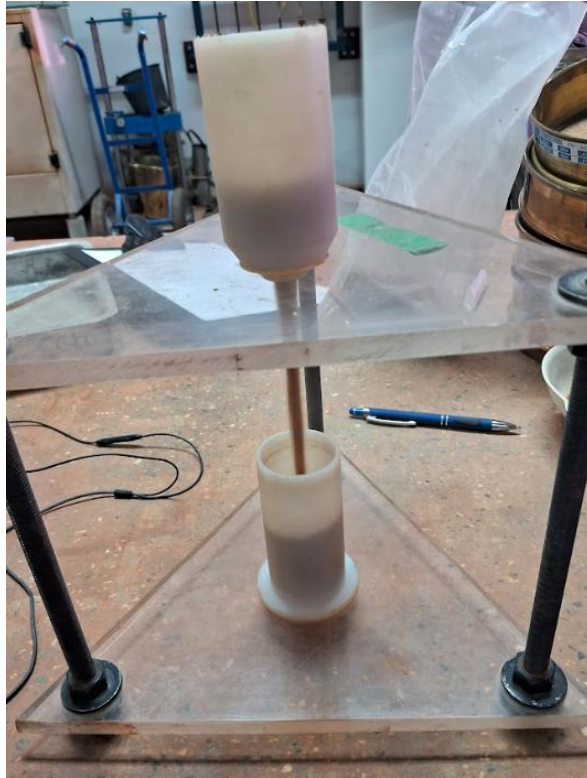
Figura 3.11. Execução do ensaio de teor de finos na areia estudada.
