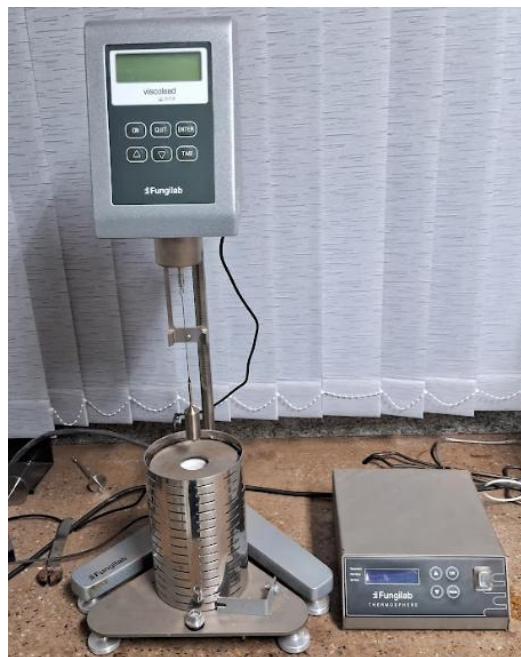
Figura 3.13. Viscosímetro Brookefield utilizado para aferir a viscosidade rotacional.
