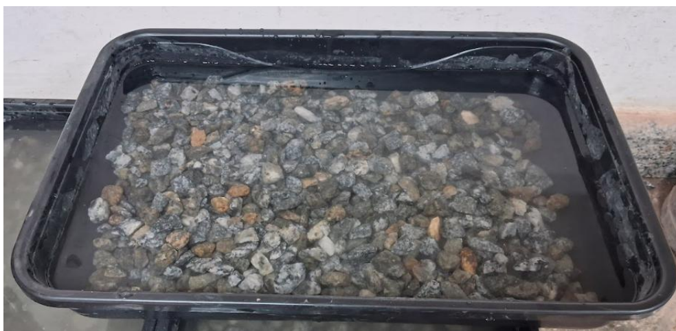
Figura 3.8. Agregados de brita 0 submersos pra o ensaio de massa específica.
