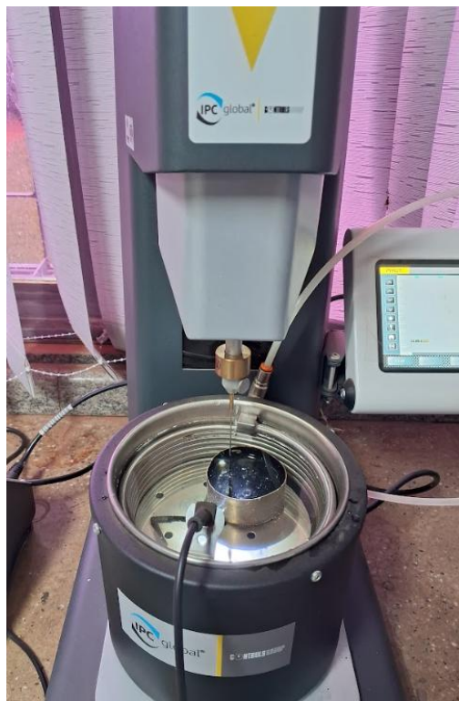
Figura 3.15. Equipamento de penetração automático da IPC Global-Controls .
