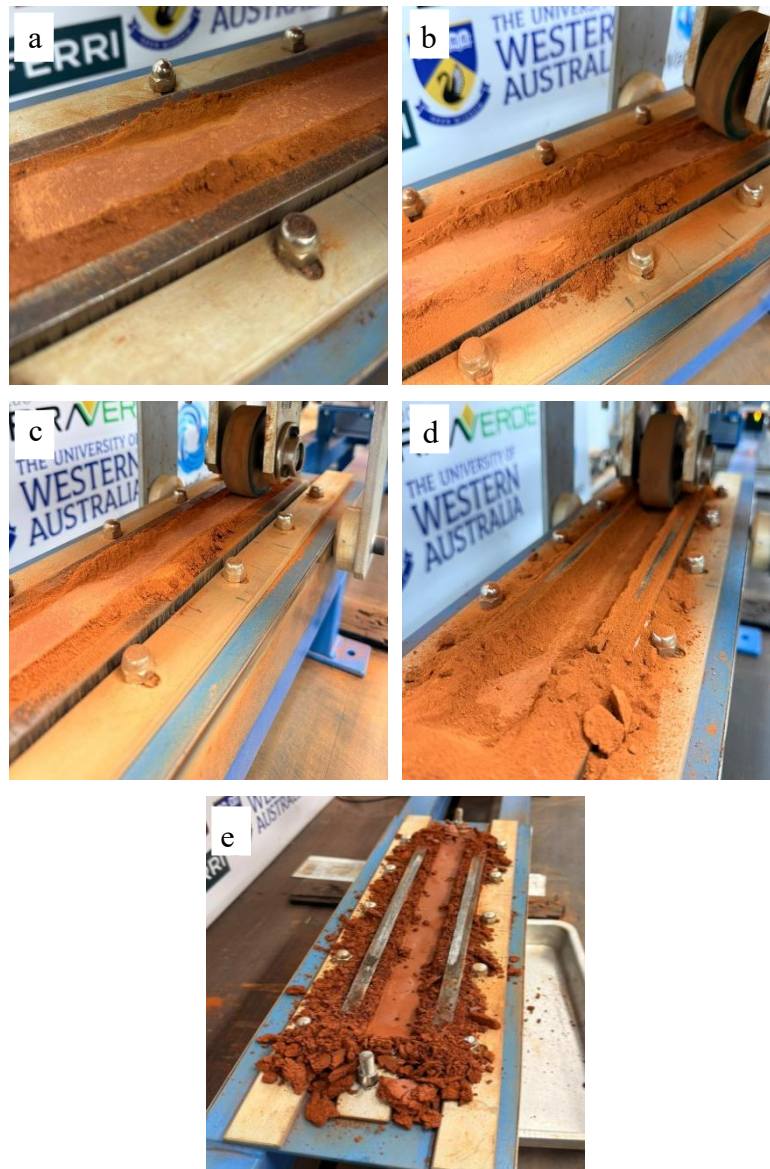
Figura 4.22 - Ensaio LWT: a) SP-S; b) SE-0.5; c) SE-8.55; d) Ensaio interrompido por afundamento máximo no solo estabilizado para SE-0.5; e) SP-Wot
