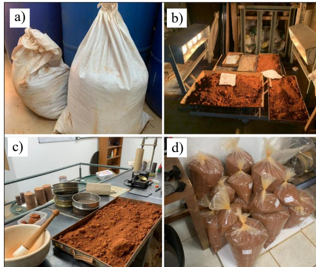
Figura 3.3 - Etapas de preparação do solo: a) transporte; b) secagem; c) destorroamento; d) armazenamento.
