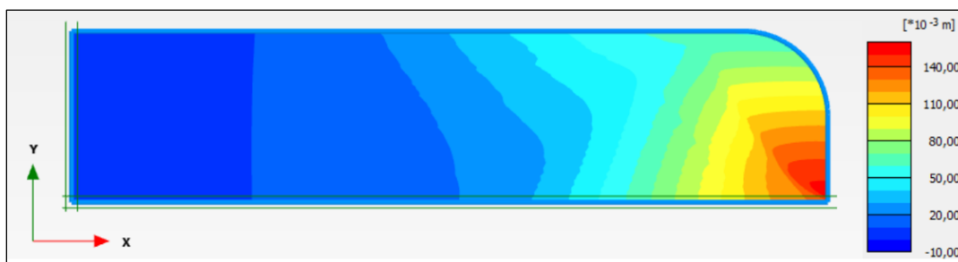
Figura 5.8 - Contornos de deslocamento horizontal u_x ao final da etapa de consolidação
