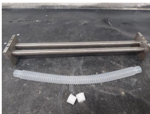
Figura 3.21 – Base de apoio do dilatômetro juntamente com molde de tubo corrugado e tampas de extremidades.
