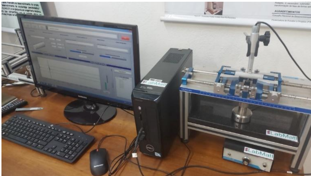
Figura 3.24 – Sistema de ensaio Sonelastic utilizado para amostras de pastas cimentícias.
