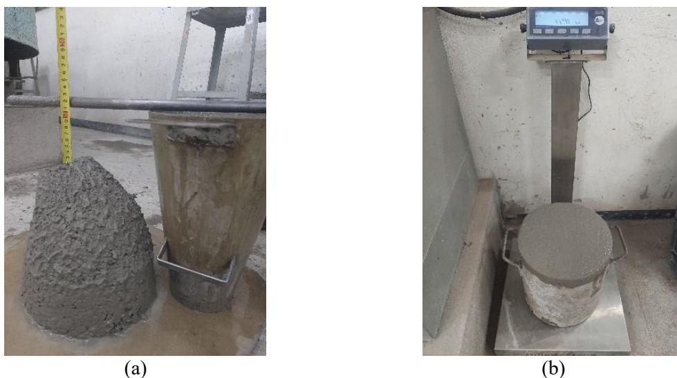
Figura 3.26 – Ensaios de caracterização do estado fresco de concretos convencionais: (a) Consistência; (b) Massa específica.
