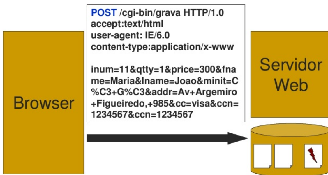
Figura 3.7: Exemplo de uma requisição HTTP do tipo POST
