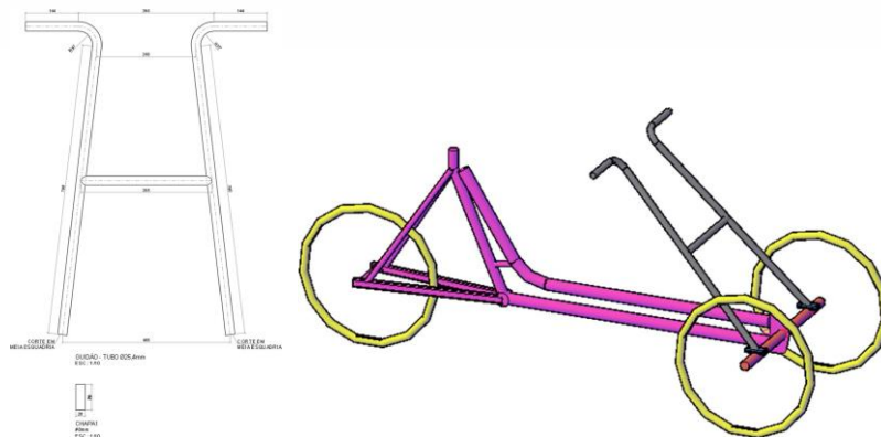
Figura 10 – Design do guidão modelado e aspecto do chassi do triciclo V1.0 com guidão manufaturado.
