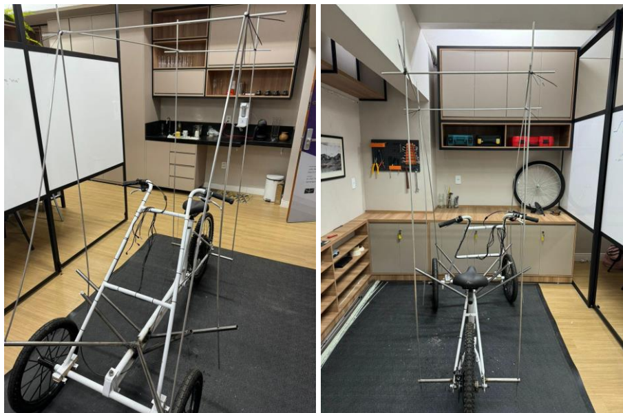
Figura17 - Tubos de alumínio posicionados no triciclo como uma representação da disposição da gaiola.
