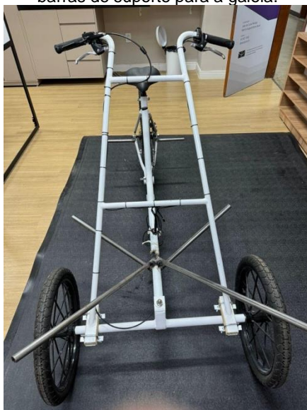
Figura 16 – Guidão fabricado acoplado ao triciclo com os freios da roda motorizada, mostrando também as barras de suporte para a gaiola.
