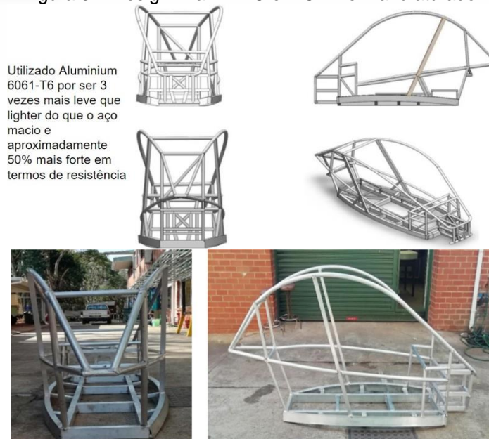
Figura 3 – Design final TREC em CAD e manufaturado.
